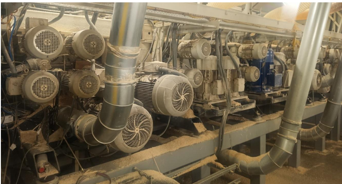
Joonis 6. Hõövel H3500, hõöveldus sektsiooni põhi mootorid.
