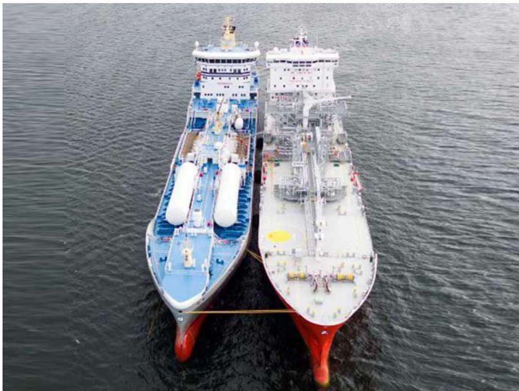
Pilt 2.3. Maailma esimene LNG punkerdamise operatsioon septembris 2016. Punkerdatav laev vasakul M/T Ternsund; punkerdamise laev Coral Energy [Marinelog]
