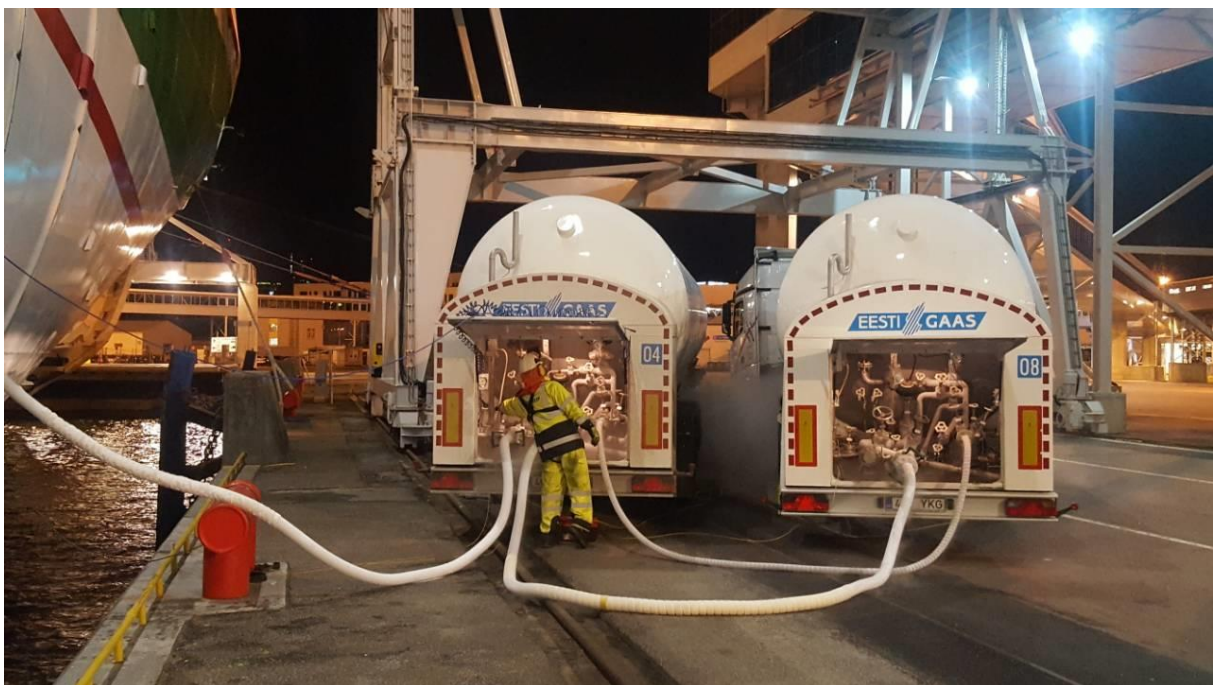
Pilt 3.3. Üks Truck-to-Ship punkerdamise variatsioonidest: ühe treileri tühjendamine teise treileri pumbaga (Megastari punkerdamise näitel)
