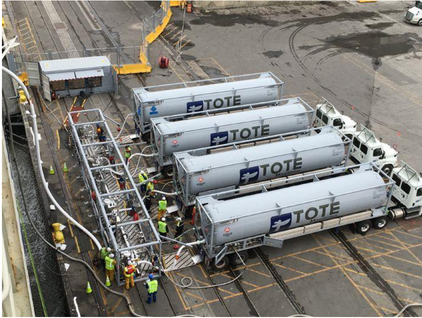
Pilt 2.1. Truck-To-Ship punkerdamise variatsioon, kasutades spetsiaalset moodulit/kollektorit, mis võimaldab üheaegselt tühendada mitut poolhaagist [Marinelog]
