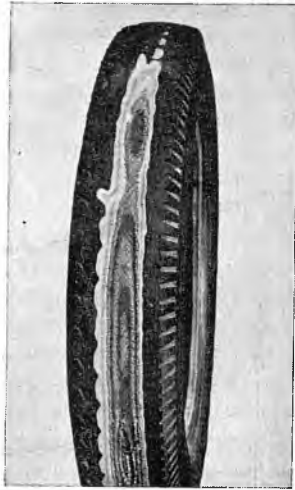
Joon. 2. Kulunud ja pidurdamise mõjul rikutud väliskummi protektor
