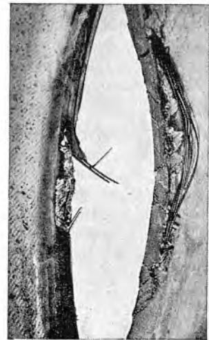
Joon. 4. Autokummi rattalt mahavõtmisel rikutud traat-mantli servad
