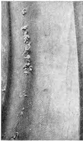
Joon. 5. Tühjalt või vähese survega, rõõplikul teel rikitud väliskummi
