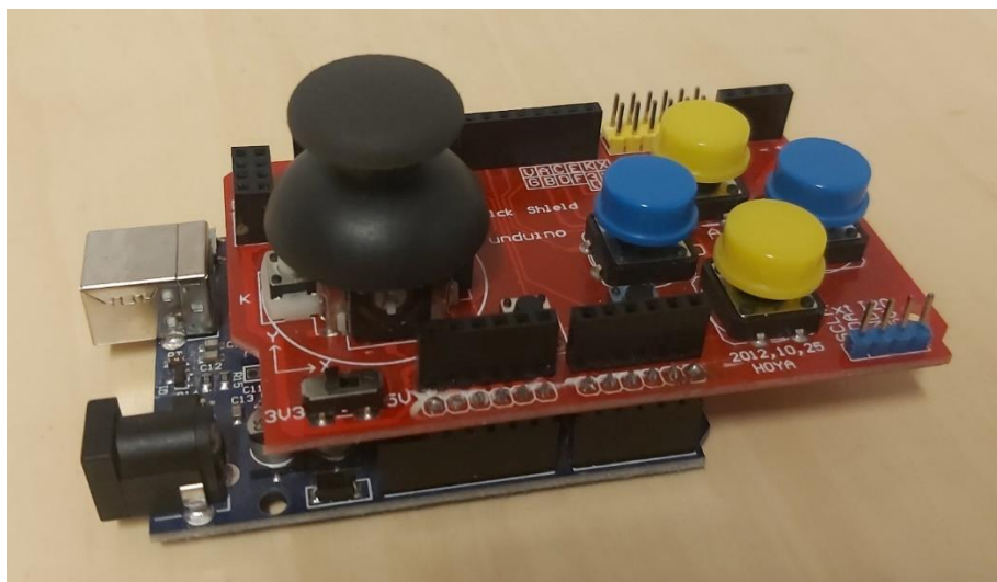
Joonis 11. Kursorhoobi kilp kinnitatuna Arduino Uno külge.
