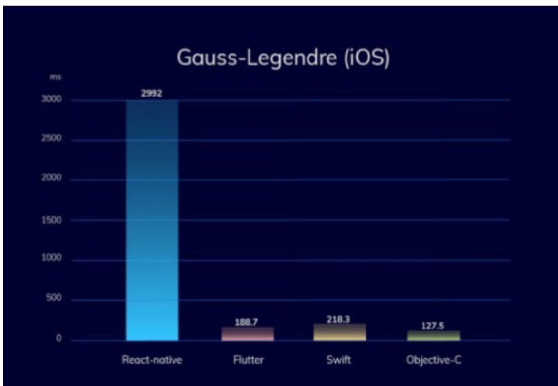
Joonis 5. React Native, Flutteri ning iOS'i programmeerimiskeelte ajakulu Gauss-Legendre algoritmiga [12]
