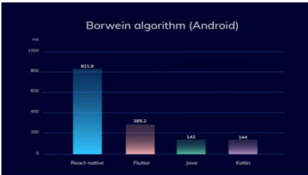
Joonis 8. React Native, Flutteri ning Androidi programmeerimiskeelte ajakulu Borwein'i algoritmiga [12]
