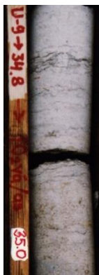
Pilt 2.35 Proovimispunkt on südamikul märgitud sügavusega meetrites.
