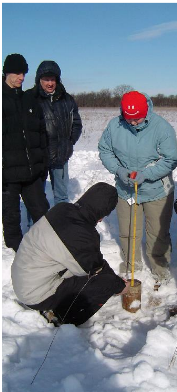
Pilt 2.10 Põhjavee taseme mõõtmine Harku ehituslubjakivi maardla vaatluskaevus
