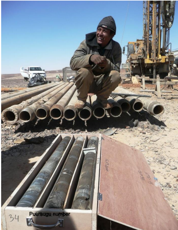
Pilt 2.5 Südamikpuurimine Jordaania põlevkivimaardlas
