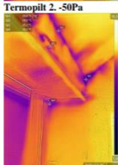
Joonis 1 Vasakul välisseina ja vahelae liitekohta õhulekke fotod enne ja pärast, paremal punktide temperatuurid ja pinnatemperatuuri suhtelise alanemise väärtused ( \Delta t_s )
