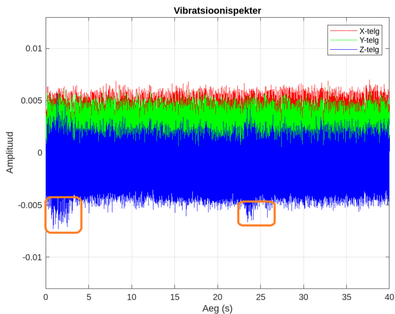
Joonis 5.4 Sisemise rõnga tõrke laagri vibratsioonisignaali 25% mootori koormatusega
