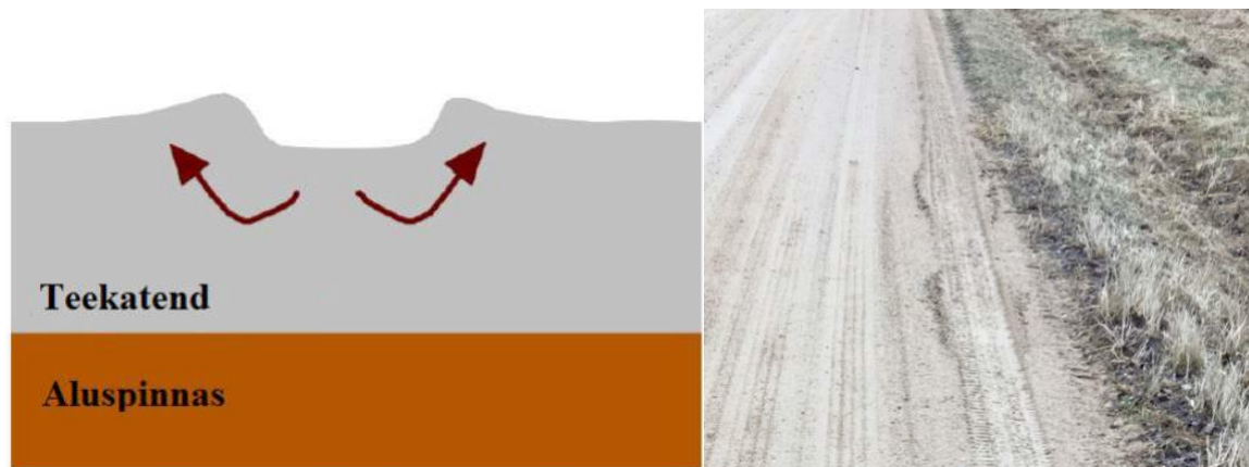
Joonis 3.1 Kui SCI väärtus on kõrge, tekivad kattesse roopad [19]
