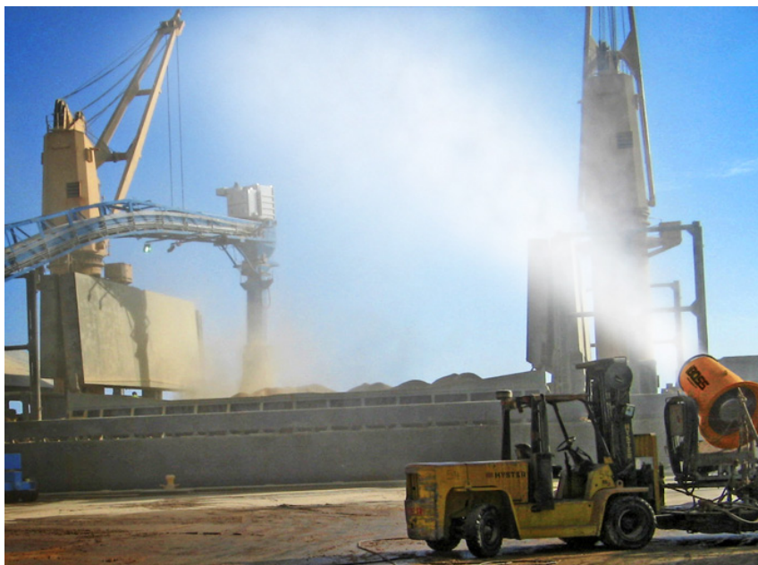
Joonis 8. Tolmu mahasurumise seadme kasutamine Port of Panama City sadamas. Allikas: (DustBoss)
