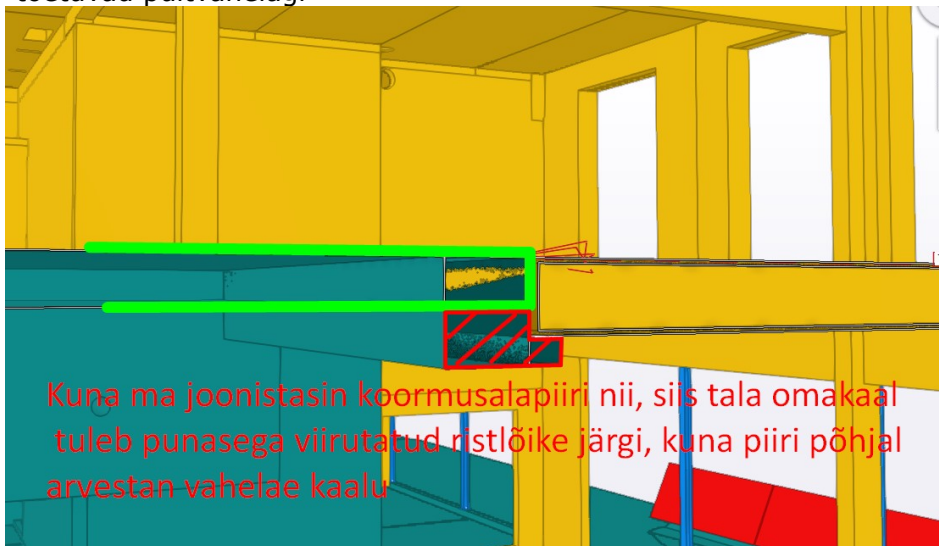
Joonis L5.2.2 Järeल्पingebetoontala otstele toetuv RB abitala
