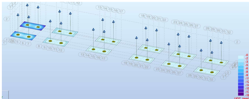
Joonis 9.4 Ankurduslappide deformeerumine
