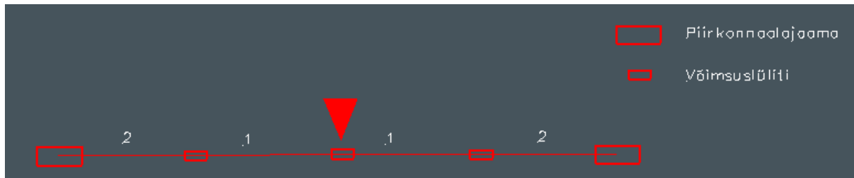
Joonis 2.7. Isetaastuva võrgu tüüpskeem
