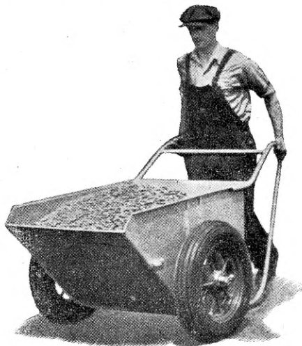
Joon. 5. Kummirehvidel ja kuullaagritel metallikärü, millega veetakse (betooni) kuni 1 tonn.
