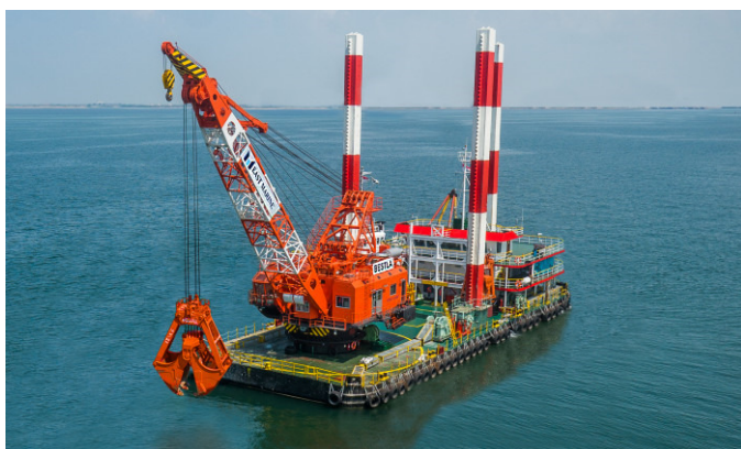
Joonis 4. Haardkopp süvendaja ühe kopaga
