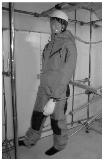
Joonis 2.1 Kõndiv termiline mannekeen rõivastuse soojusisolatsiooni mõõtmiseks.
