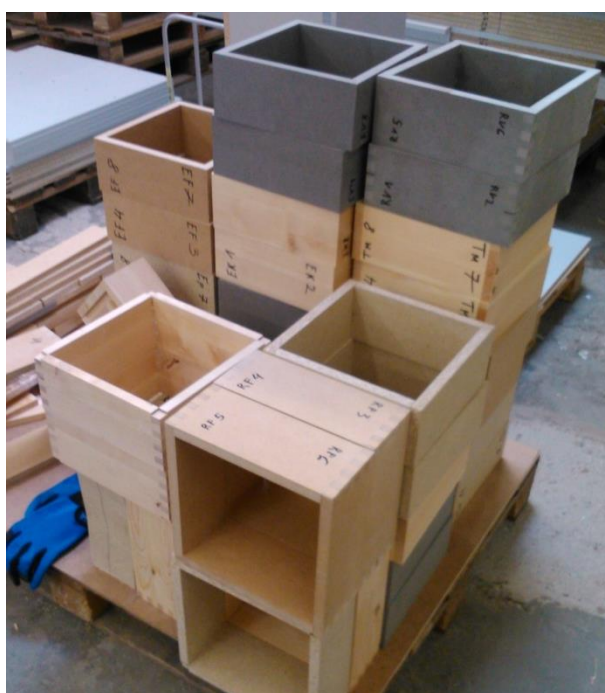
Joonis 11. Valmistatud katsekehade kastid, enne lahtilõikamist
