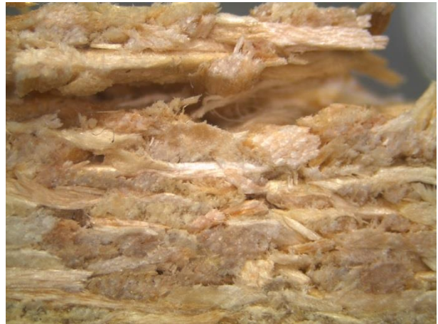
Joonis 45. Murdunud PLP ristikiud 32x suurendusega
