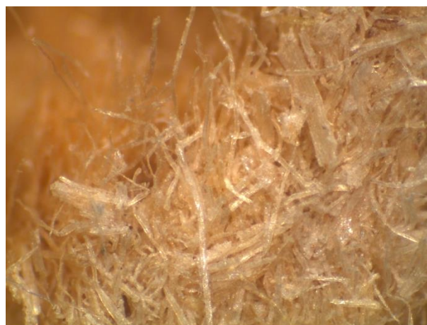
Joonis 41. MDF-i purunenud kiud 32x suurendusega
