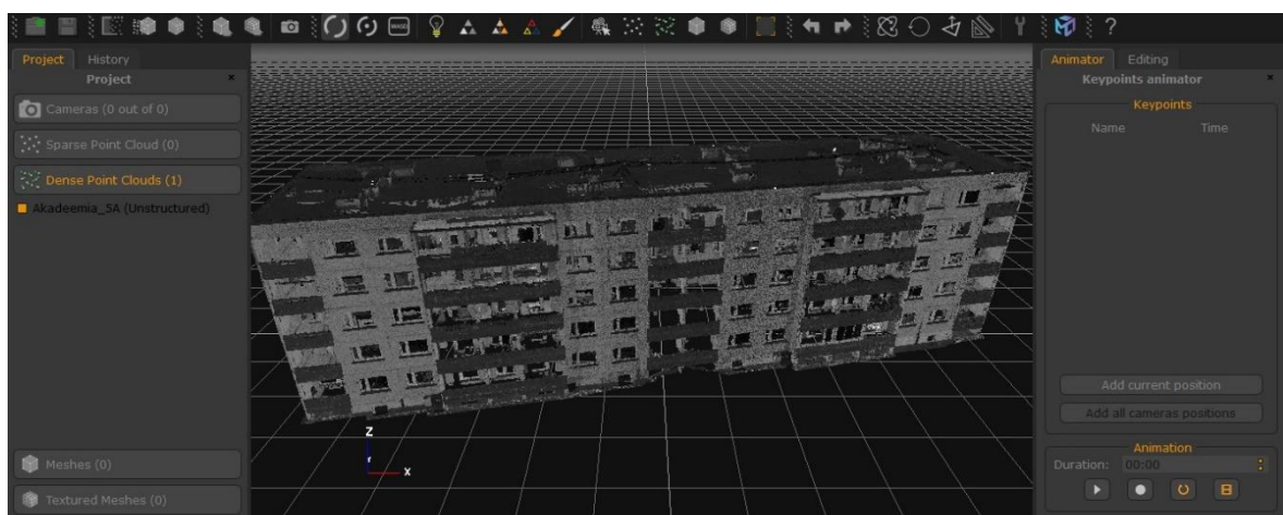
Joonis 52. Punktipilv 3DF Zephyr programmis. Punktipilv kuvatakse täies ulatuses. Rõdud ja aknad on hästi eristatavad. Programmi stiil on must ning tarkvara värvib punktipilve mustaks ja halliks. See tekitab kohati probleeme objekti vaatamiseks. Kahjuks, tarkvara ei võimalda muuta stiili või värve, et saaks arusaadavam vaadata projekte. Hilisema uurimuse osas on värve võimalik muuta, ent tudengi programmi kasutuse ajal töö autor selleni ei jõudnud.
