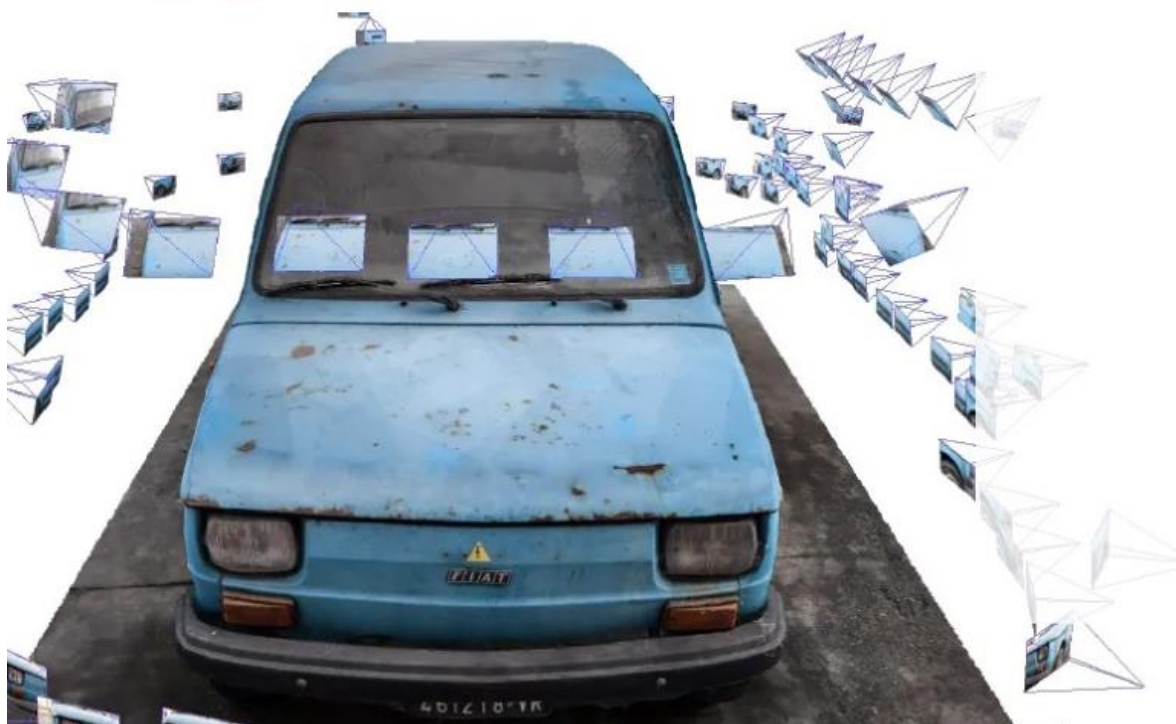
Joonis 51. Näide 3DF Zephyris piltide põhineva mudeli loomise kohta [3DFLOW, 2021]. Terve pilt koosneb väikestest fotolõikudest. Fotod on hästi ühendatud, nii et sidumislõigud pole nähtavad.
