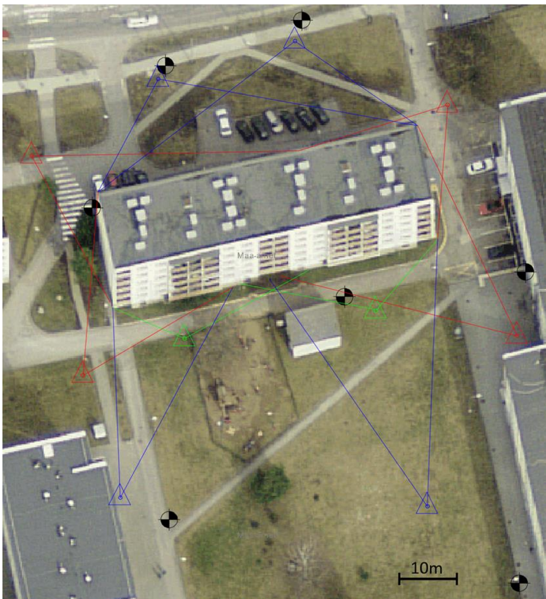
Joonis 11. Fassadi laserskaneerimise jaamade ja tähiste paiknemise skeem [Julge,2016]. On toodud uuritava hoone Akadeemia tee 5A laserskaneerimise jaamade ja tähiste paiknemise skeem, kolmnurkadega on tähistatud jaamade asukohad ja ringidega kindelpunktid.
