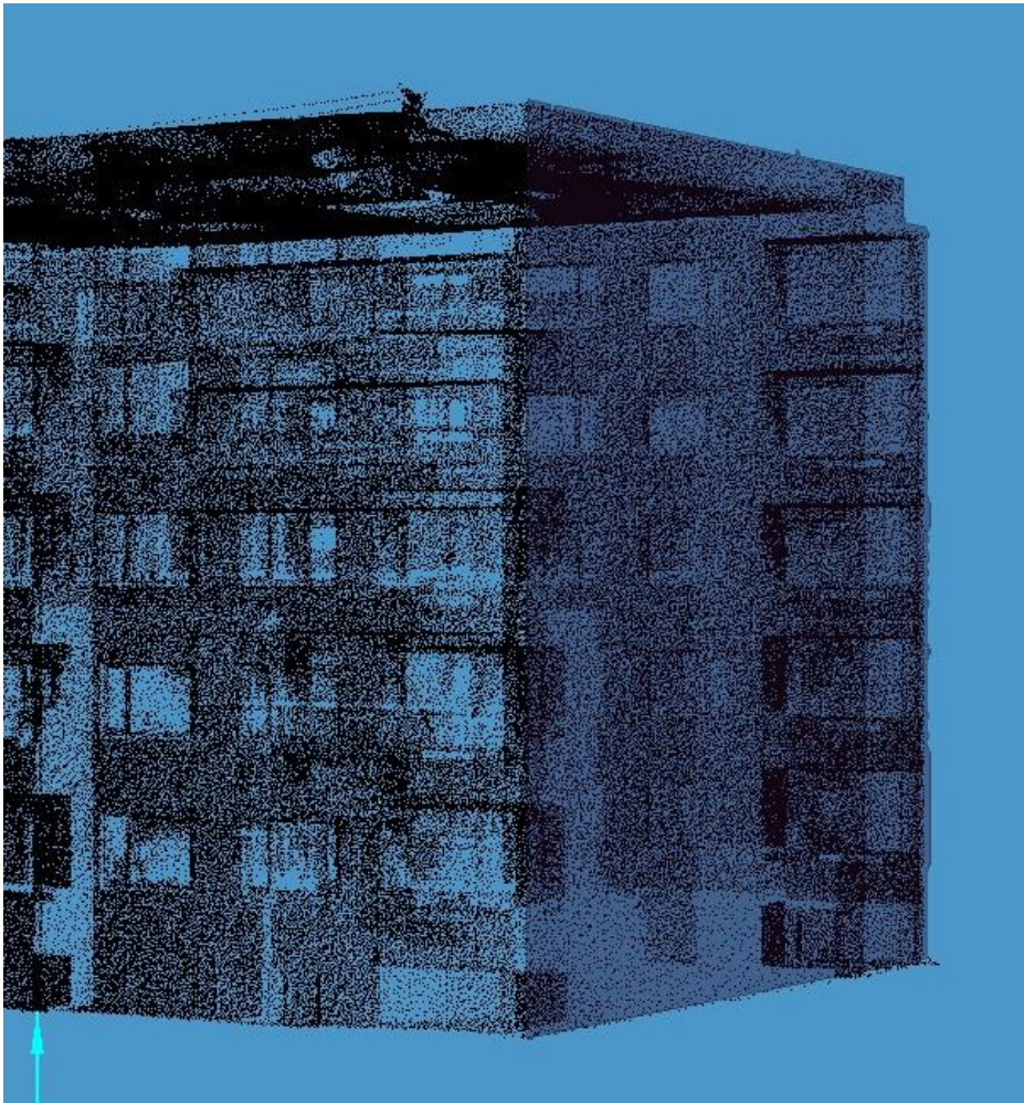
Joonis 33. Valitud punktid külgeina tasapinna konstrueerimiseks. Valitud hoone külgeina kuvamine on läbipaistva lilla tooniga.
