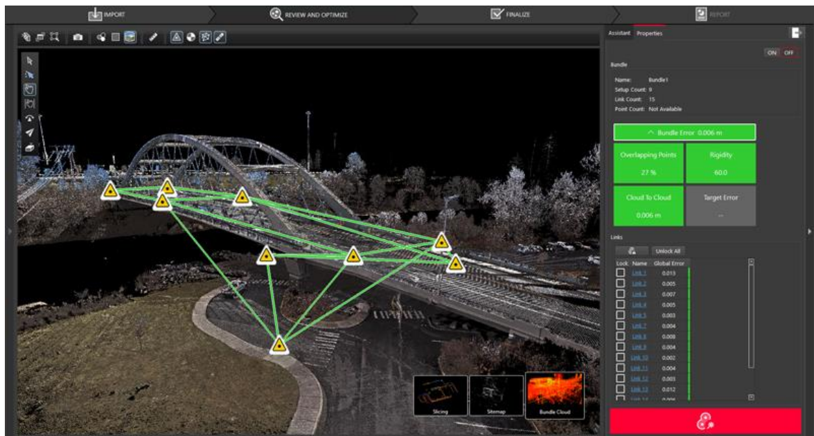
Joonis 9. Leica Cyclone liides [Leica Geosystems,2021]. Paremal pool on toodud programmi tööaken ja üleval tööikoonid, millega ei ole vaade liigselt koormatud. Tarkvaras kasutatakse musta tausta, mida muuta ei saa.
