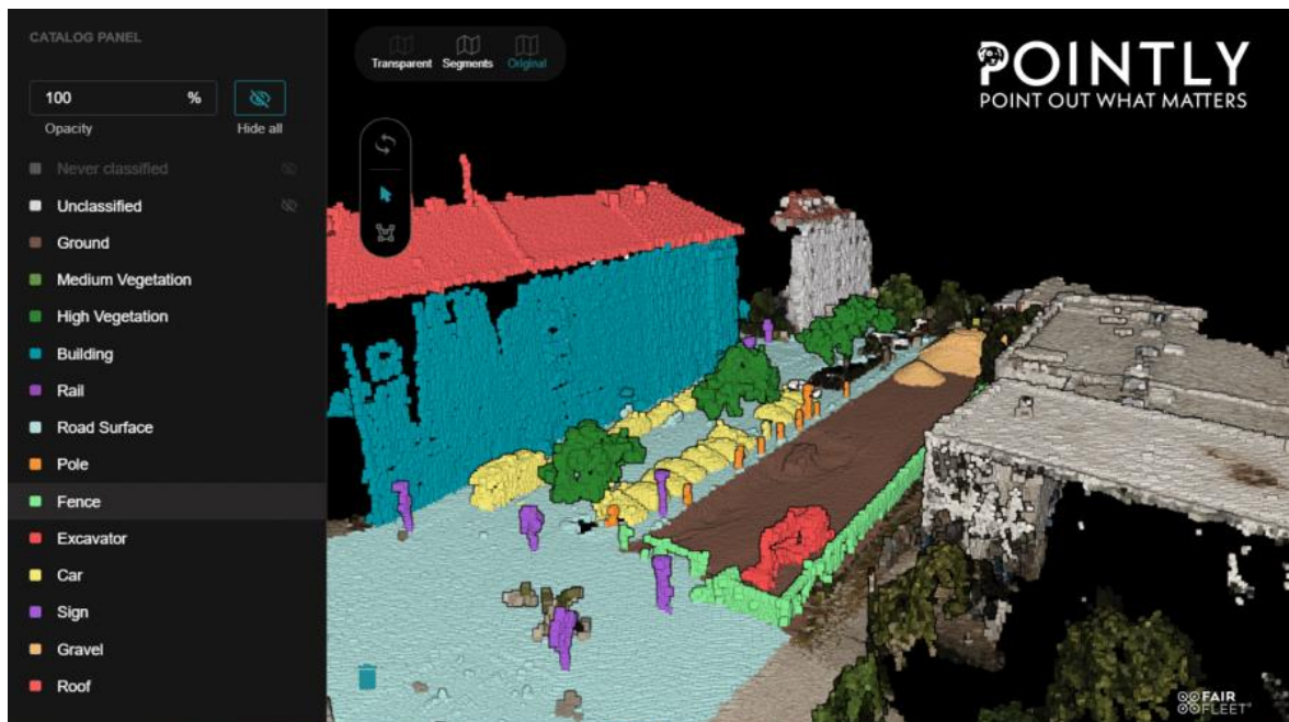
Joonis 67. Pointly liides [Geoinformatics, 2020]. Tarkvara pole töötamiseks ikoonidega üle koormatud. Tööaken on suur ja tööriistade valik on vasakul.
