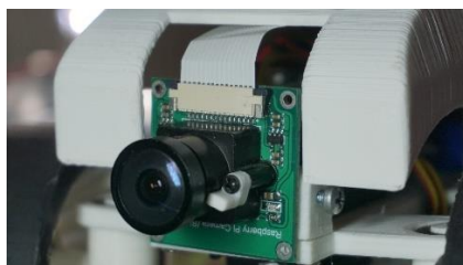
Joonis 10. Raspberry Pi 2.0 kaamera robotile kinnitatud ja ühendatud.
