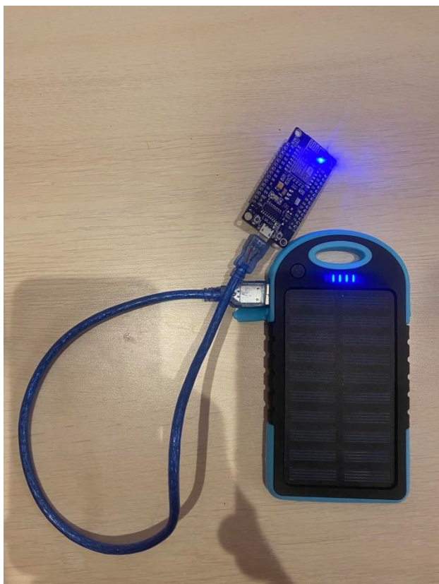
Joonis 6. Prototüübi raadiosaatja koos akupangaga.
