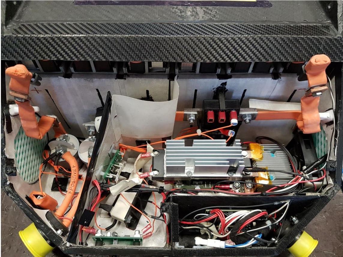
Joonis 3.5. Akukasti elektroonika seksioon
