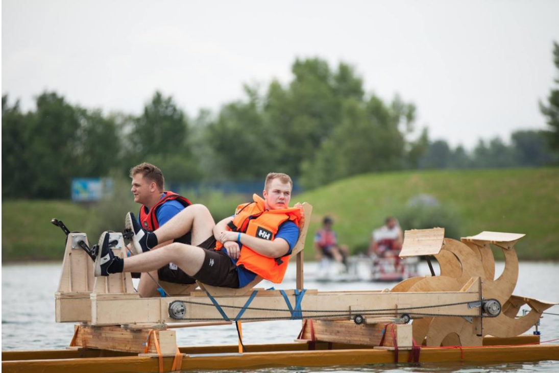
Joonis 5. Puidust katamaraan tüüpi vesijalgratas sõurattaga. [3]
