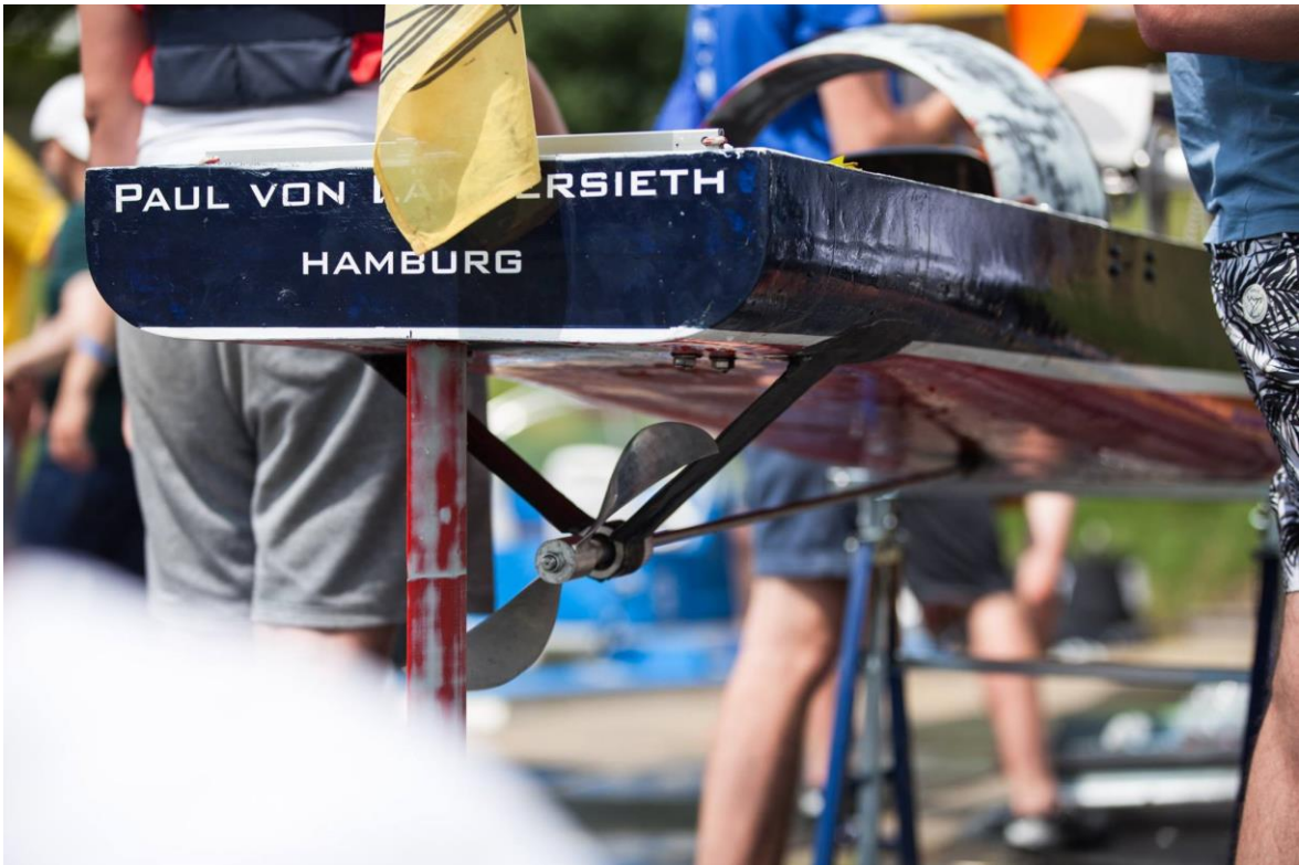
Joonis 2. Ahtrist väljuv sõuvõll [3]
