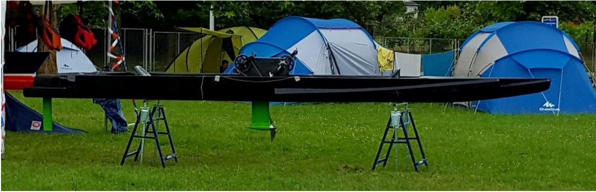
Joonis 3. Saildrive jõuülekandega monohull vesiratas [3]
