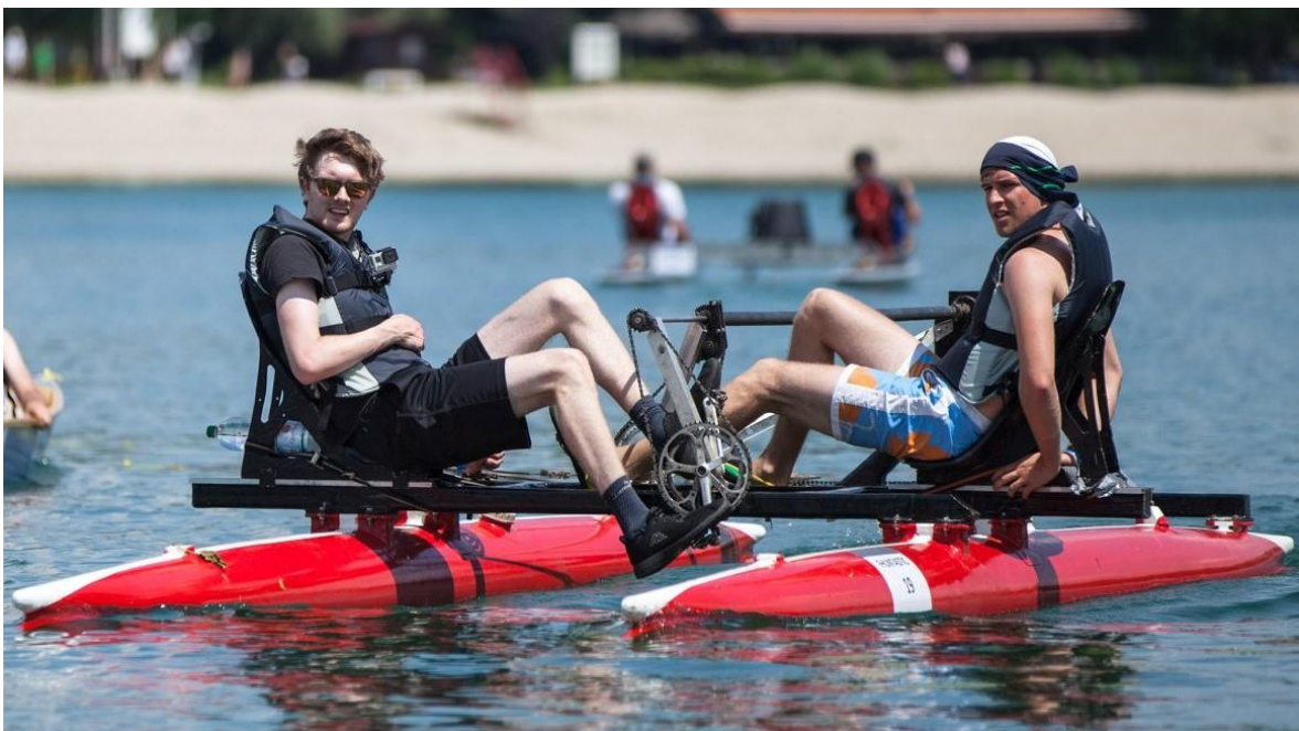
Joonis 8. Külg ees sõitev tandemvesiratas
