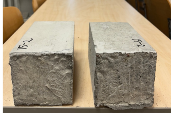
Foto 50. 18-tunnise valamisviivitusega 20 °C keskkonnas ja niisutatud katsekeha purunemispind. Autori erakogu
