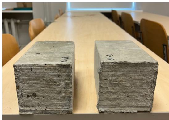
Foto 29. Lihvimise tolmu harjaga pühitud pärast 7-päevast valamisviivitust, katsekeha purunemispind. Autori erakogu
