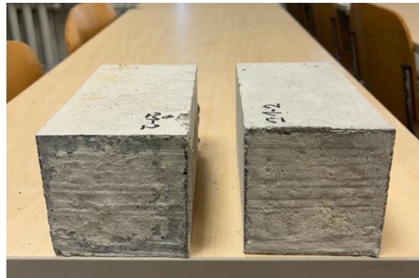
Foto 44. 18-tunnise valamisviivitusega 60 °C keskkonnas olnud ja niisutatud katsekeha purunemispind. Autori erakogu
