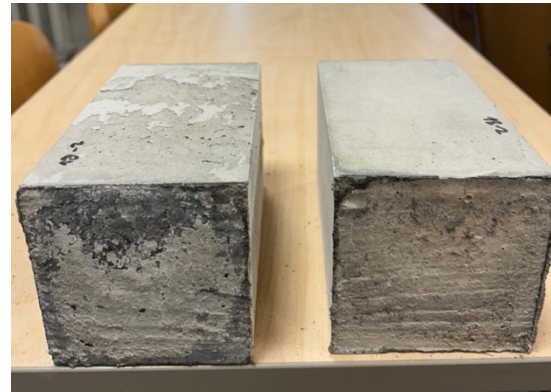
Foto 24. 60 °C keskkonnas, 18-tunnise valamisviivitusega katsekeha purunemispind. Autori erakogu
