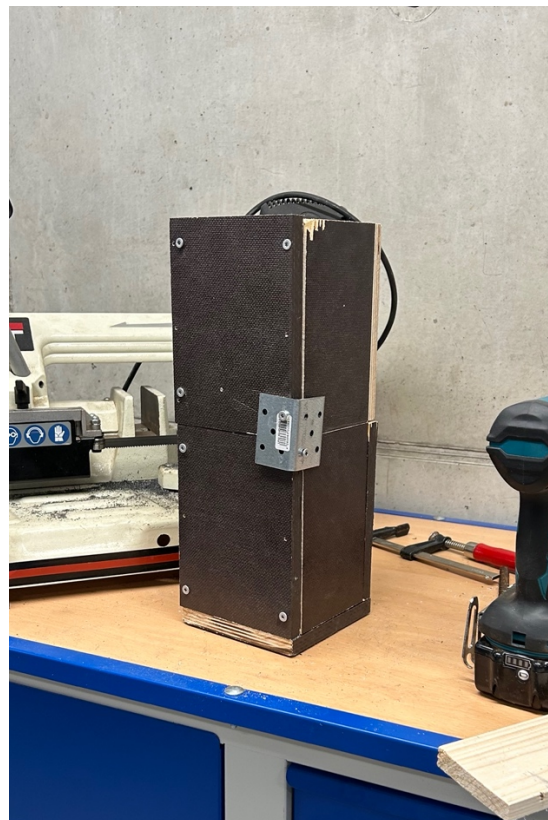
Foto 2. Raketise ülemine osa on kinnitatud alumisele. Autori erakogu
