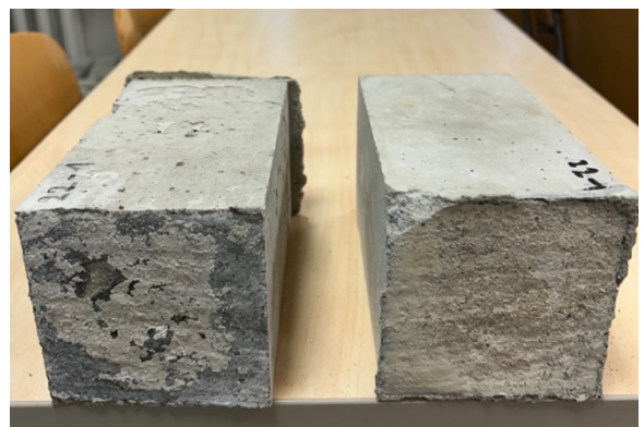
Foto 46. 7-päevase valamisviivitusega 60 °C keskkonnas ja niisutatud katsekeha purunemispind. Autori erakogu
