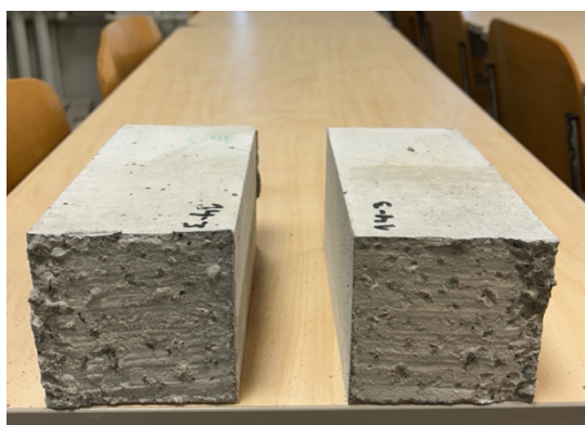
Foto 19. 20 °C keskkonnas, 4-tunnise valamisviivitusega ja niisutatud katsekeha purunemispind. Autori erakogu
