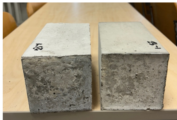
Foto 32. Silumata pinnaga 7-päevase valamisviivitusega katsekeha purunemispind. Autori erakogu
