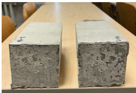
Foto 52. 7-päevase valamisiivitusel 20 °C keskkonnas ja niisutatud katsekeha purunemispind. Autori erakogu
