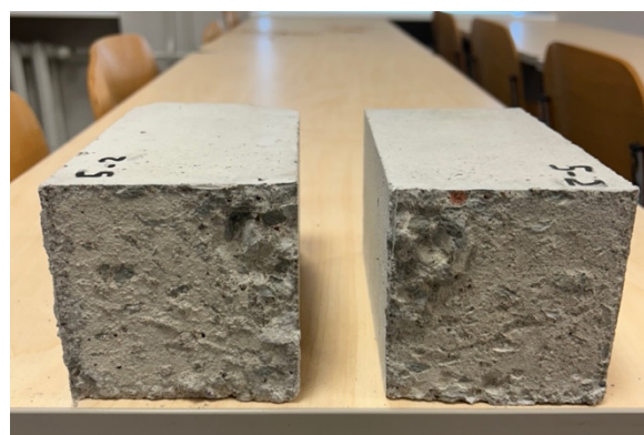
Foto 20. 20 °C kaetud keskkonnas, 4-tunnise valamisviivitusega katsekeha purunemispind. Autori erakogu
