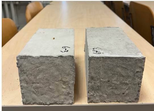
Foto 23. 20 °C kaetud keskkonnas, 18-tunnise valamisviivitusega katsekeha purunemispind. Autori erakogu
