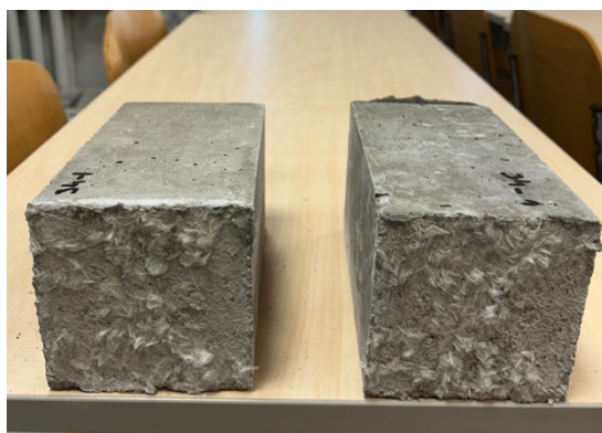
Foto 33. Puistatud fiibrikihiga 7-päevase valamisviivitusega katsekeha purunemispind. Autori erakogu
