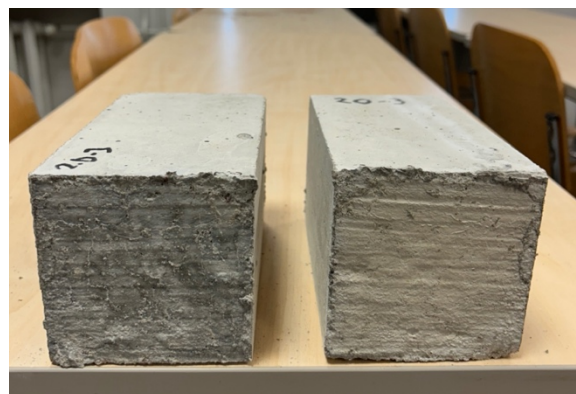
Foto 22. 60 °C keskkonnas, 4-tunnise valamiseviivitusega ja niisutatud katsekeha purunemispind. Autori erakogu
