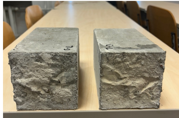
Foto 40. C25/30 rohke veega katsekeha purunemispind. Autori erakogu
