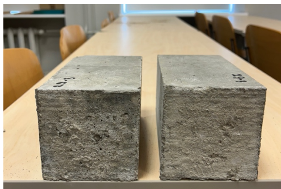
Foto 30. 1 mm lihvistolmu pärast 7-päevast valamisviivitust, katsekeha purunemispind. Autori erakogu
