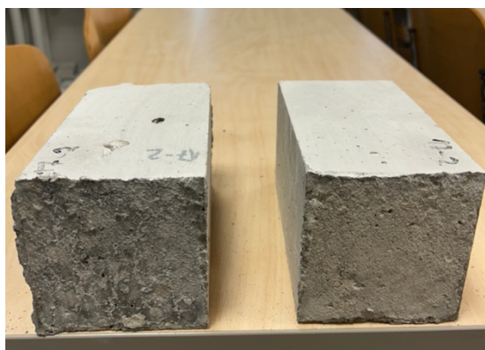
Foto 21. 60 °C keskkonnas, 4-tunnise valamiseviivitusega katsekeha purunemispind. Autori erakogu
