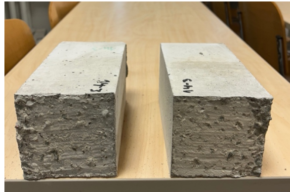
Foto 48. 4-tunnise valamisviivitusega 20 °C keskkonnas ja niisutatud katsekeha purunemispind. Autori erakogu
