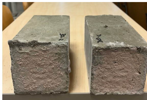
Foto 34. 5-millimeetrise lihvimistolmuga 7-päevase valamisviivitusega ja niisutatud katsekeha purunemispind. Autori erakogu
