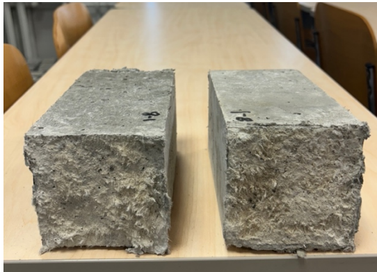
Foto 39. C25/30 fiibriga katsekeha purunemispind. Autori erakogu
