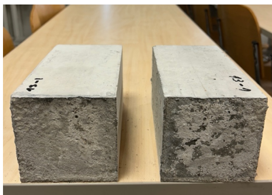
Foto 31. Kelluga silutud 7-päevase valamisviivitusega katsekeha purunemispind. Autori erakogu
