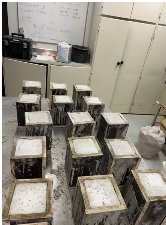
Foto 6. Katsekehade valatud alumised pooled. Autori erakogu
