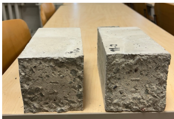
Foto 18. 20-kraadises keskkonnas, 4-tunnise valamisviivitusega katsekeha purunemispind. Autori erakogu
