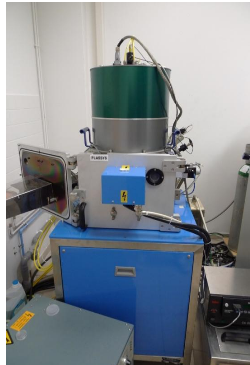
Pilt 15. RIE varustus LNIOs, MU 400 PLASSYS, mida kasutatakse domeenide söövitamiseks.
