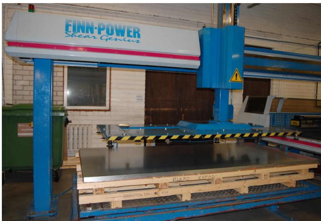
Sele 1.2 Toormaterjali laadimissüsteem LD3000
