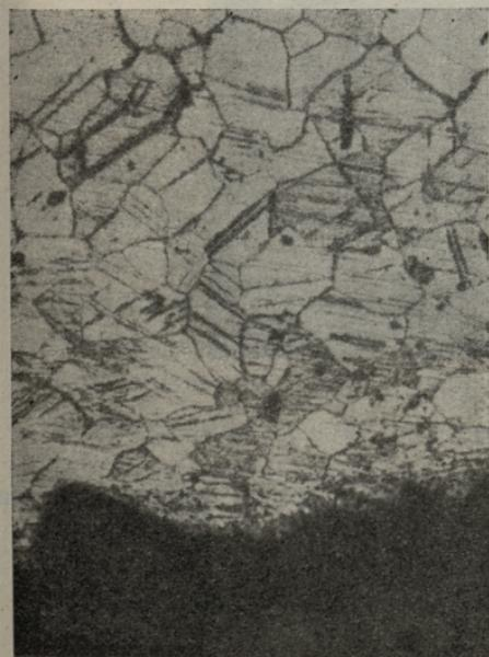
Фиг. 5. Изношенная поверхность образца из железа Армко, скорость струи 82 м/сек, песок 0,4...0,62 мм,  $\alpha = 90^\circ$
