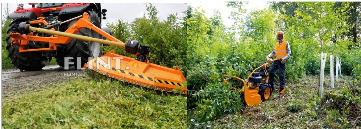
Sele 4.1. Traktorile tahakinnituv ja käsitsi lükatav võsaniiduk [4], [5]
