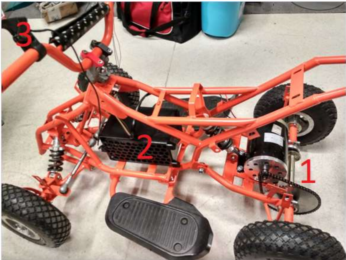
Joonis 2.5 Elektrikartauto, 1 – elektrimootor, 2 – elektroonika kast, 3 - pidur
