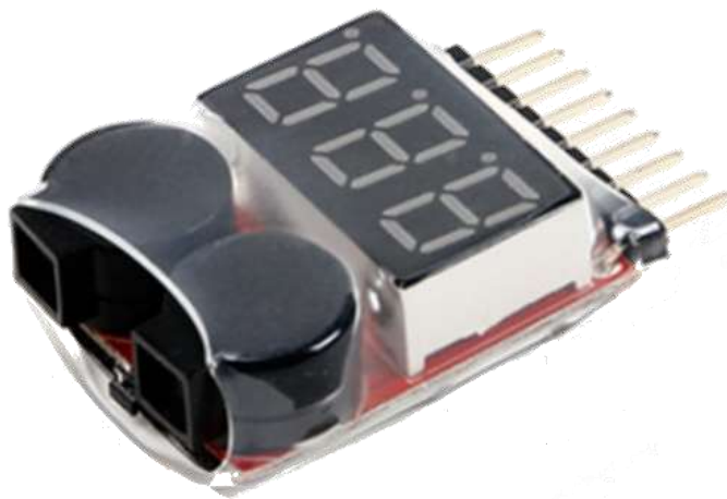
Joonis 1.16 LiPo akude pingemõõduri näide [18]
