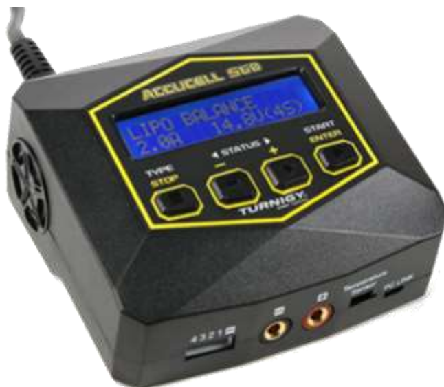
Joonis 1.10 LiPo akupatareide laadija [16]
