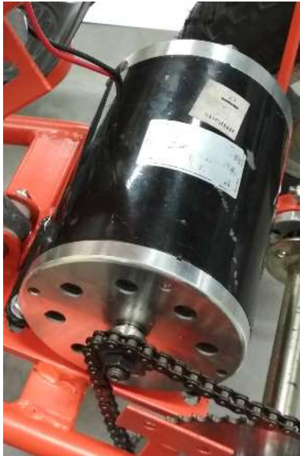
Joonis 2.4 Mootori paigutus elektrikart autol
