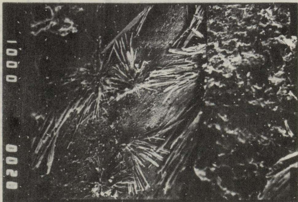
Рис. 2. Электронная микрофотография при увеличении в 1000 раз. Между песчинкой и цементным камнем видны новообразования. 10% СЗ-2. ТВО 95 °С, твердение в воде.
