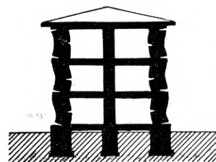
Joon. 5. Praod painde tõttu, mis on esile kutsutud välisseinte lühenemisest. Skemaatiline plaan ja lõige.
