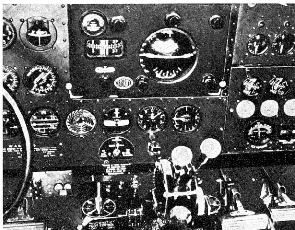
Joon. 4. Pilt kujutab Sperry robotlenduriga varustatud lennuki Douglas DC-2 osutusriistade lauda. Ülal keskel näeme robotlenduri osutusriistu: suunavurri ja kunstlikku horisonti ja nende ümber nuppe kursi, kõrguse jne. muutmiseks. All näeme robotlenduri pealüliti (sisse- ja väljalülitamiseks).
