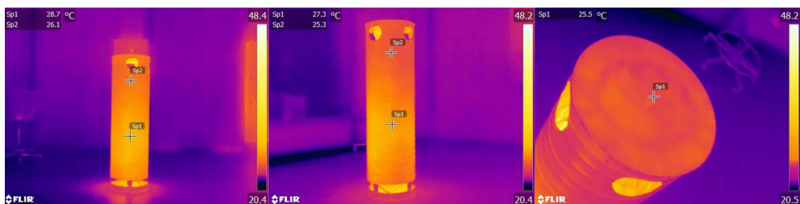
Joonis 20. 80 W soojusväljastusega termilise mannekeeni pinnatemperatuur. Paremt vasakule: termilise mannekeeni ava paralleelne termokaameraga, termiline mannekeen termokaamera suhtes 45° pööratud ning pealtvaade.
