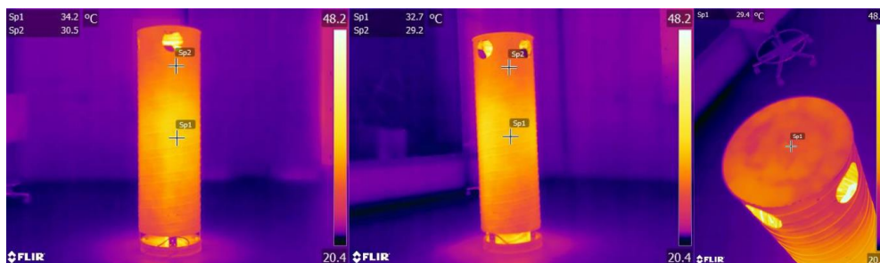
Joonis 21. 180 W soojusväljastusega termilise mannekeeni pinnatemperatuur. Paremt vasakule: termilise mannekeeni ava paralleelne termokaamergaga, termiline mannekeen termokaamera suhtes 45° pööratud ning pealtvaade.
