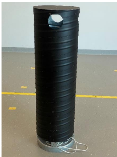
Joonis 10. EVSN 14240:2004 järgi ehitatud termiline mannekeen
