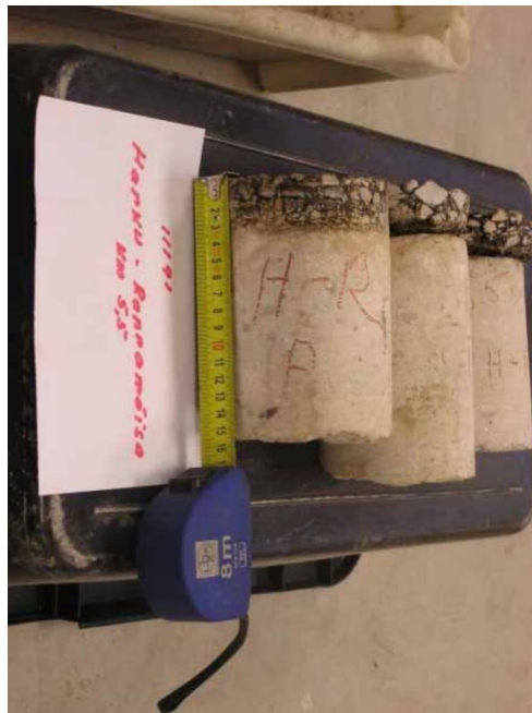
Joonis 4.4 Harku-Rannamõisa teelt välja puuritud katsekehad [17]
