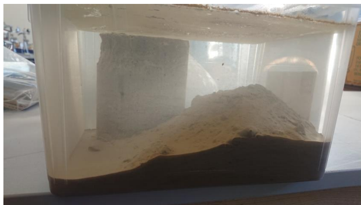
Joonis 4.4 Põlevkivituhaga töödeldud katsekeha vasakul ja töötlemata katsekeha paremal asetatuna vette [erakogu]
