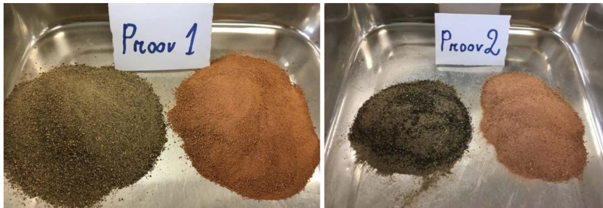
Foto 5.11 Proovid 1 ja 2 enne (vasakul) ja pärast (paremal) kuumutuskaotus määramist: orgaanikasisaldused olid proovidel vastavalt 3,5 ja 5,0% [erakogu]
