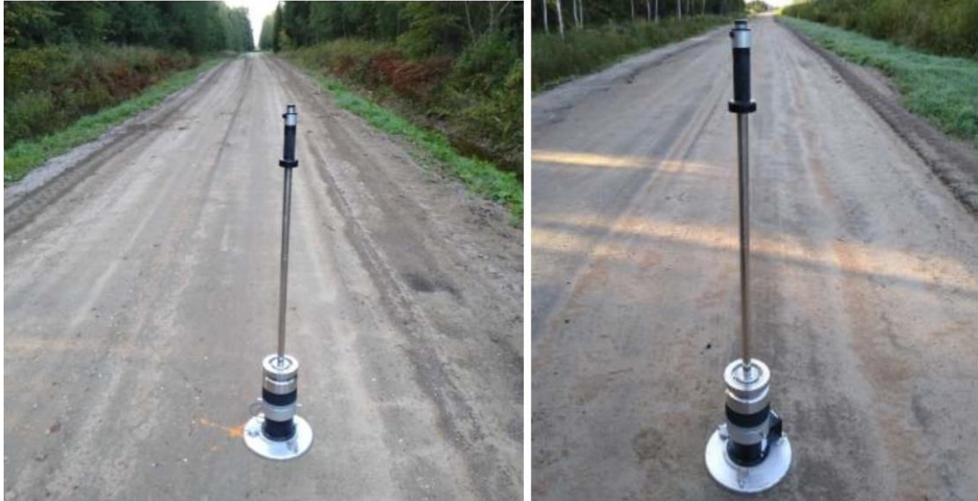
Joonis 5.20 Kandevõimemõõtmised Rahingu teel (vasakul) ja Taarikõnnu teel (paremal) Dynatest LWD seadmega 28p peale põlevkivituhaga segamist [erakogu]
