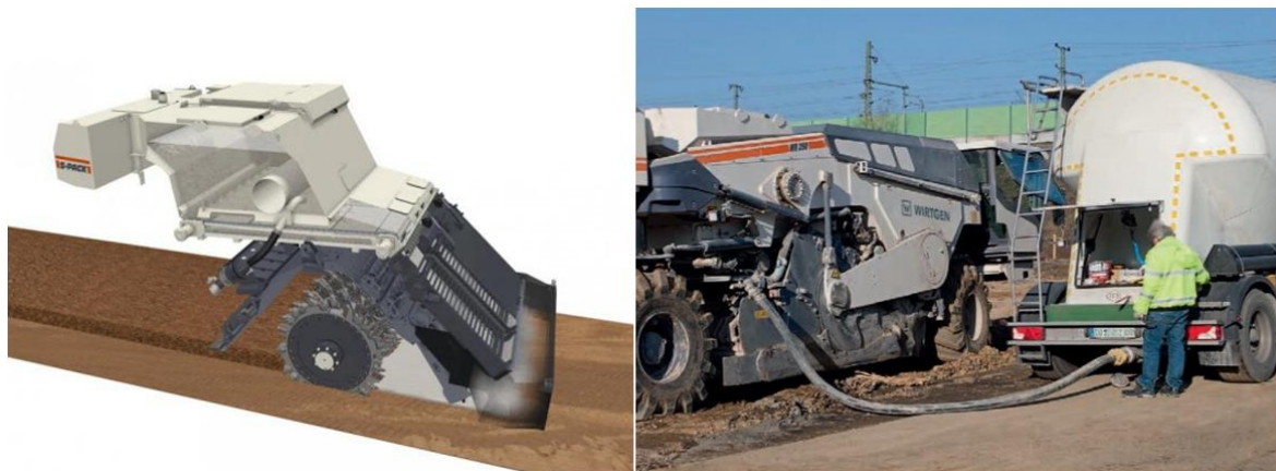
Joonis 3.3 Laotamiseseadmega segamisfrees (vasakul) [10], sideaine laadimine tsisternist otse segamisfreesi punkrisse (paremal) [10]
