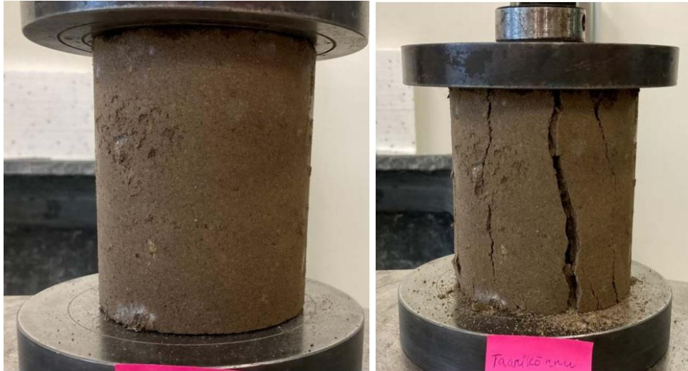
Joonis 5.15 survetugevustesti sooritamine [erakogu]
