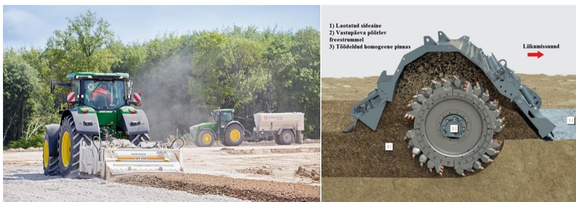
Joonis 3.1 Põllumajandustraktorile liidetud segamisfrees (vasakul) [9], segamisfreesi tööorgan (paremal) [10]
