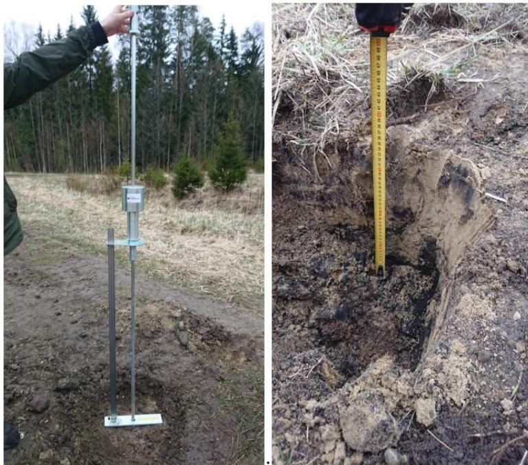
Joonis 5.4 Pinnase penetratsiooni katse (vasakul), läbilõige teekonstruktsioonist (paremal) [erakogu]
