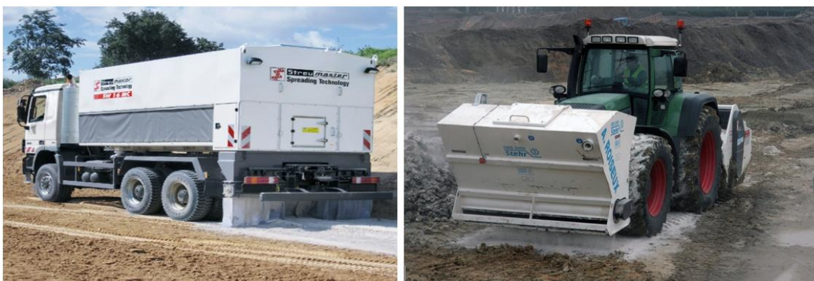
Joonis 3.2 Sideaine puisteseade (vasakul) [11], lisaaine dosaator (paremal) [12]
