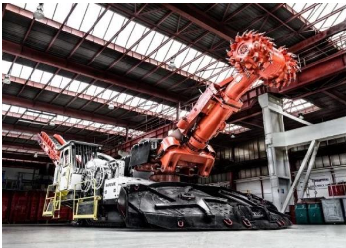
Joonis 19 . Valik tööorganiga kombain Sandvik MT720 (Sandvik, 2019)
