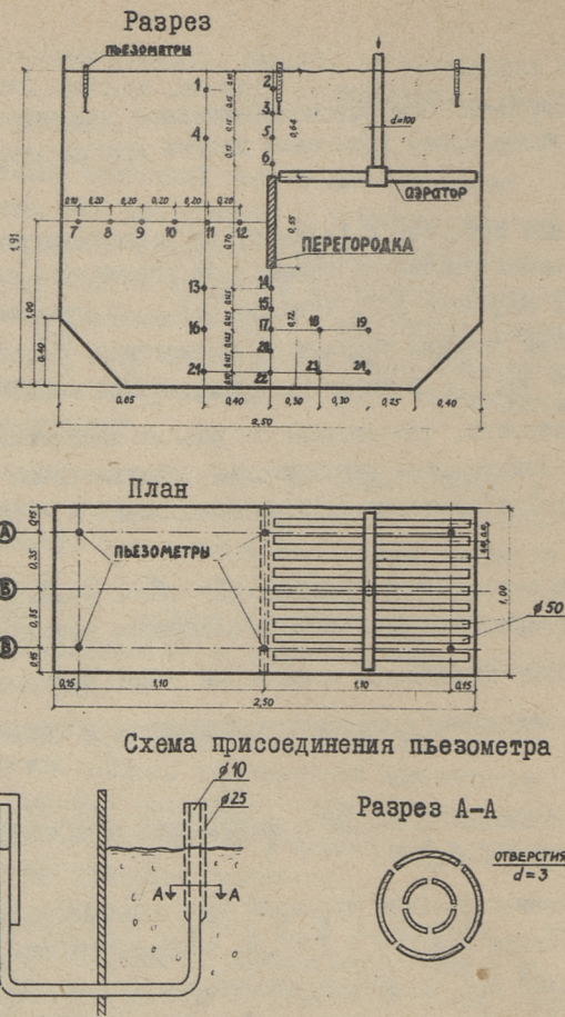
Фиг. 1. Схема опытного аэротенка (объем V = 4,6 \text{ м}^3 )
