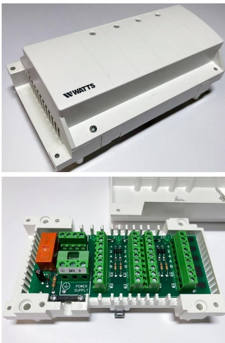
Рис. 6.1 Базовый модуль на 4 зоны WFHC-40717 Master, Watts [\[33\]](#)
