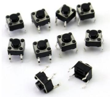
Рис. 5.8 Кнопки для управления микроконтроллером [\[26\]](#)
