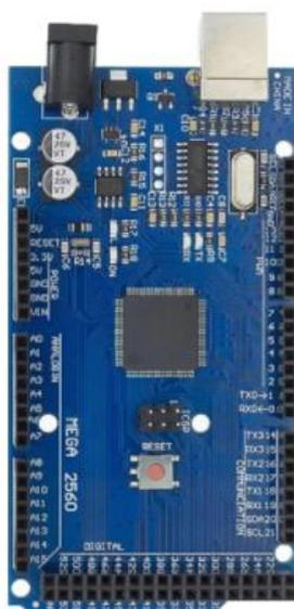
Рис. 5.1 Плата Arduino Mega 2560 [\[18\]](#)
