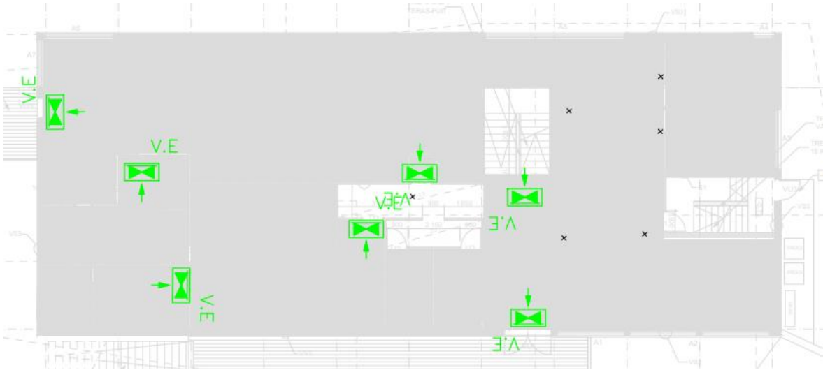
Joonis 3.1. Olemasoleva hädavalgustussüsteemi skeem
