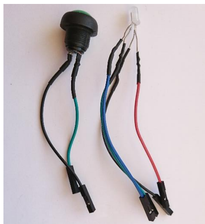
Joonis 3. Pilt väliskomponendid koos joodetud juhtmetega.
