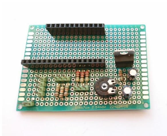
Joonis 4. Pilt makettplaadile joodetud prototüübist.
