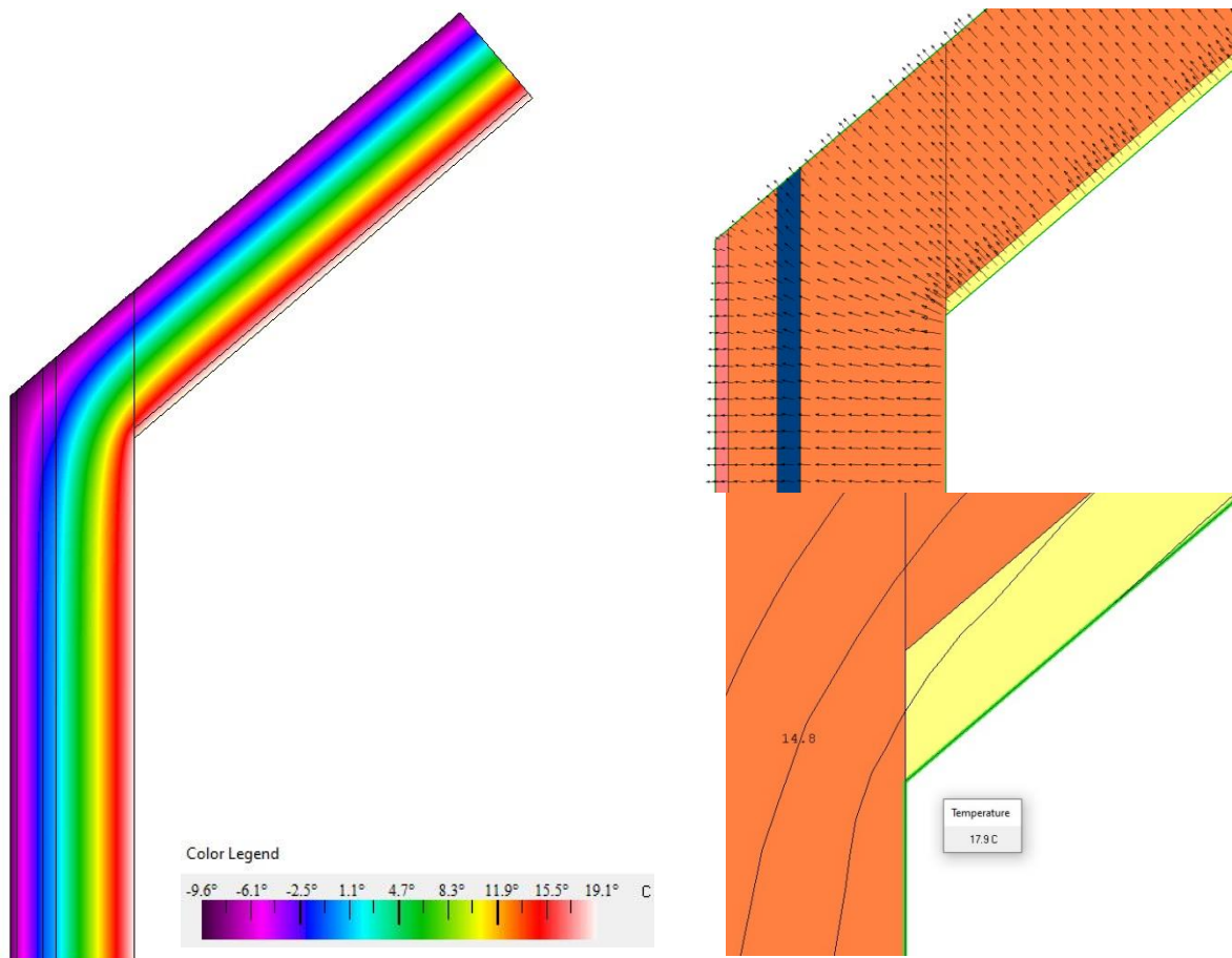
Joonis 1.8 Katuse ja välisseina ühendussõlme simulatsioon.
