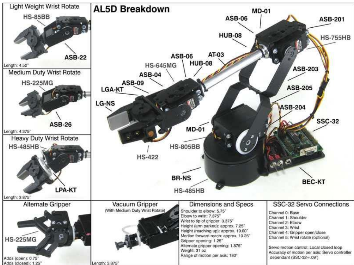
Sele 1.1. AL5D komponentide asetus ja spetsifikatsioonid
