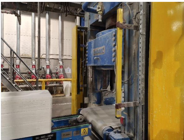
Joonis 2.4 ja 2.5 Pakipressi lintkonveier
