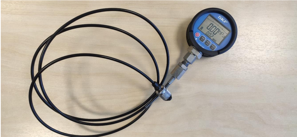
Joonis 1. Digitaalne manomeeter SKF THGD 100
