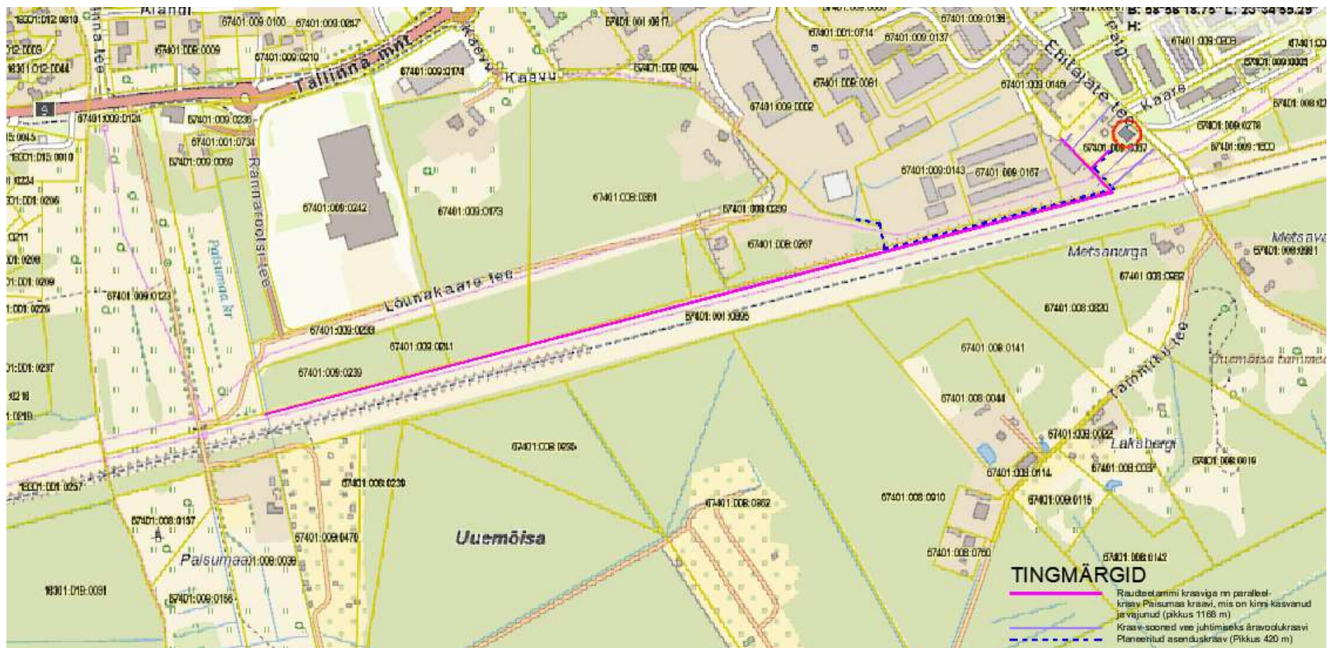
Joonis 11. Endine kraav, mis on kinni vajunud ja kasvanud koos uue kraavi lahendusega. Lisatud ka Ehitajate tee 10 kraavituse, mis juhhib Ehitajate tee liigveed äravoolusüsteemi. Aluskaart www.maaamet.ee
