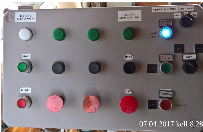
Joonis 5. Juhtpult poolvagunite liigutamiseks haruteedelt nr 7 ja 14
