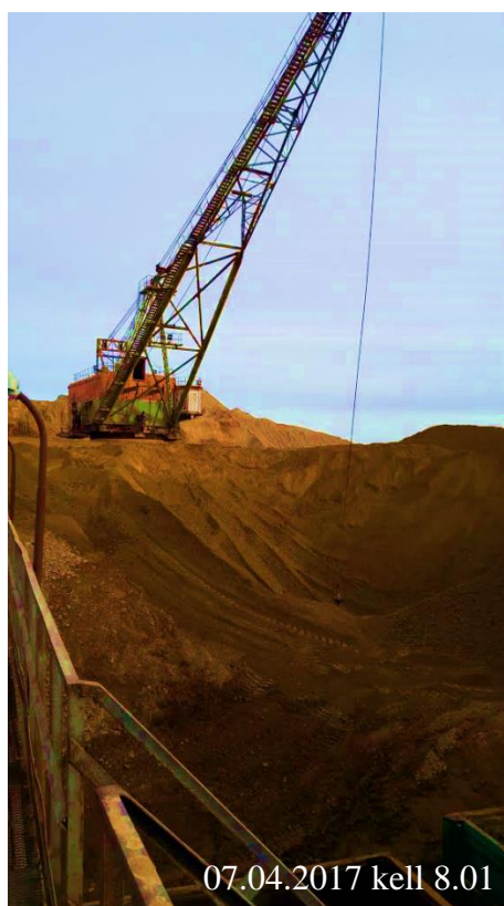
Joonis 4. Draglain EIII6.5/45Y põlevkivi laadimas
