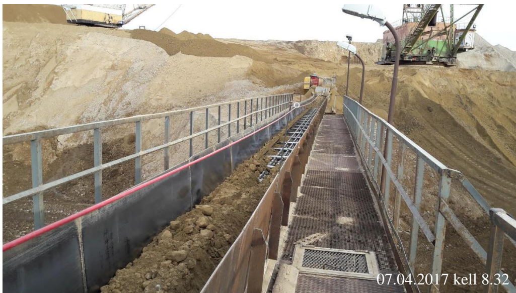
Joonis 3. Kraapkonveier SP-1-228 poolvagunite laadimiseks
