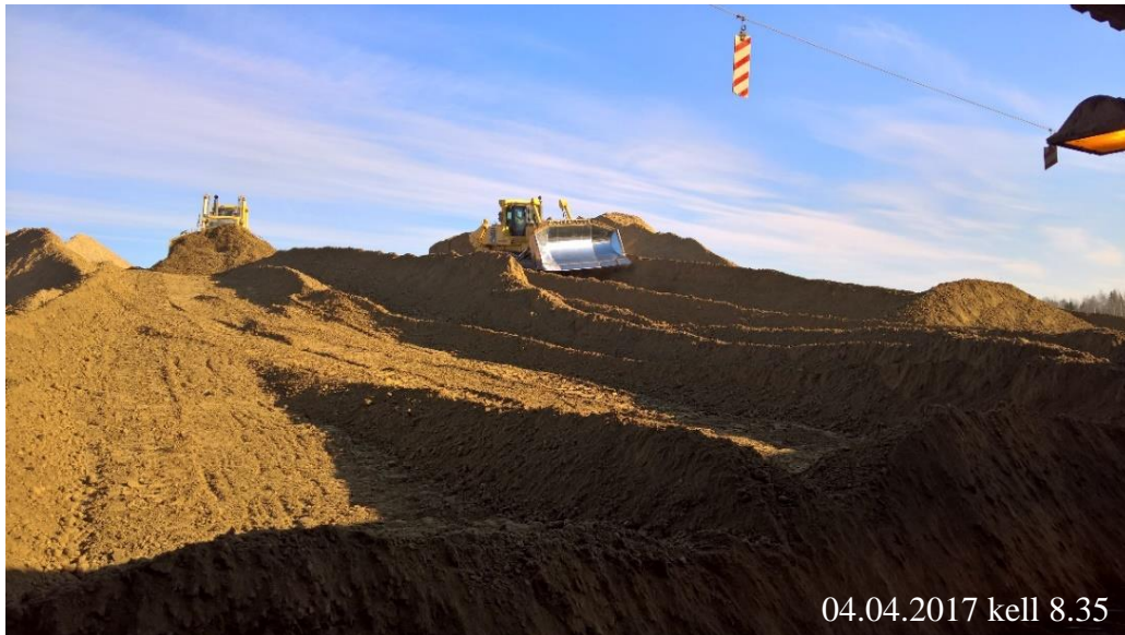
Joonis 6. Buldooserid Komatsu D375 A6 ja 375A-5EO põlevkivi poolvagunitesse lükkamas
