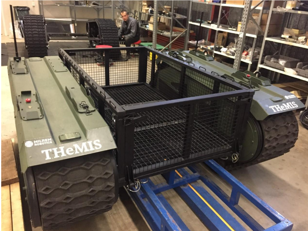
Sele 5.5 Projekteeritud masina töstelaud/testseadme alusraam
