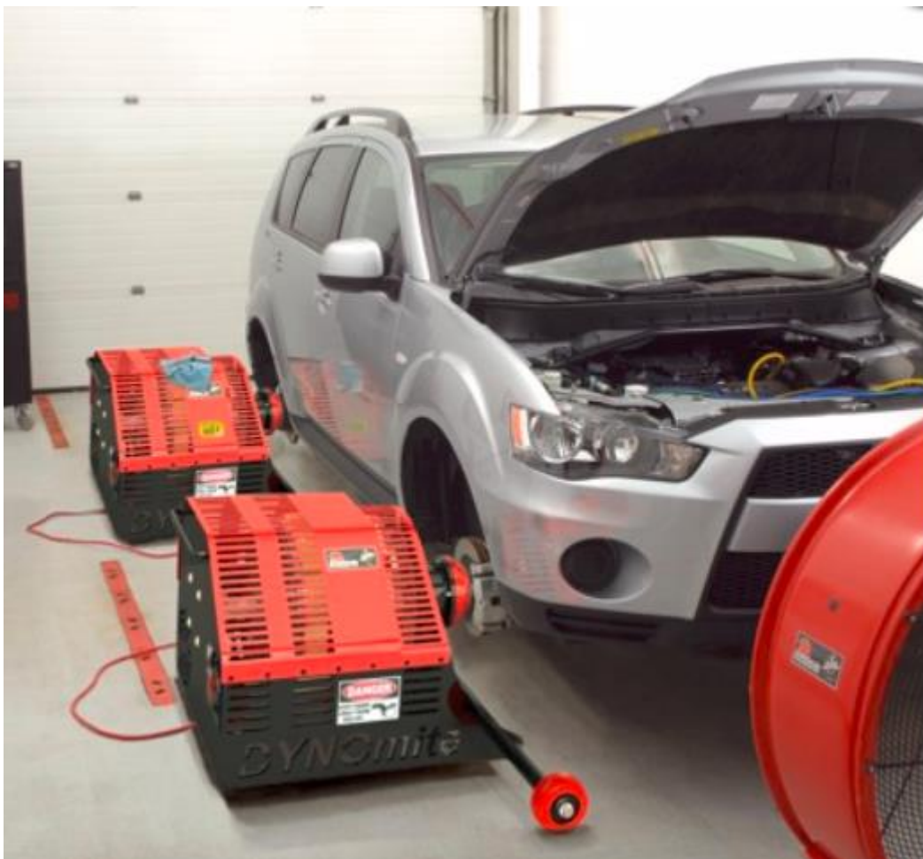
Sele 3.2 Rummu külge kinnitatav dünamomeeter [3]
