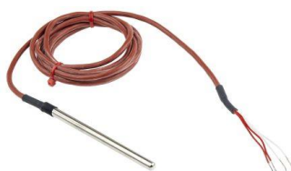
Рисунок16. Температурный датчик Pt100. Тип W-CABLE-6/100-10000/SIL-4-A [5]
