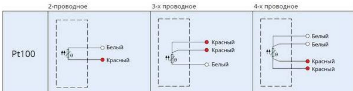
Рисунок 18. Подключение 2-х, 3-х, 4-х проводного датчика Pt100 [7]
