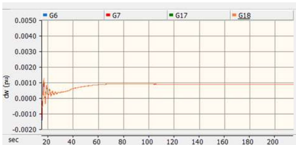
Joonis 3.10 Generaatorite G6, G7, G17 ning G18 rootorite kiiruste kõrvalekalded pärast 4032-4044 liini avamist (PSCAD, talitluspunkt A, liini avamine 15 sekundil).
