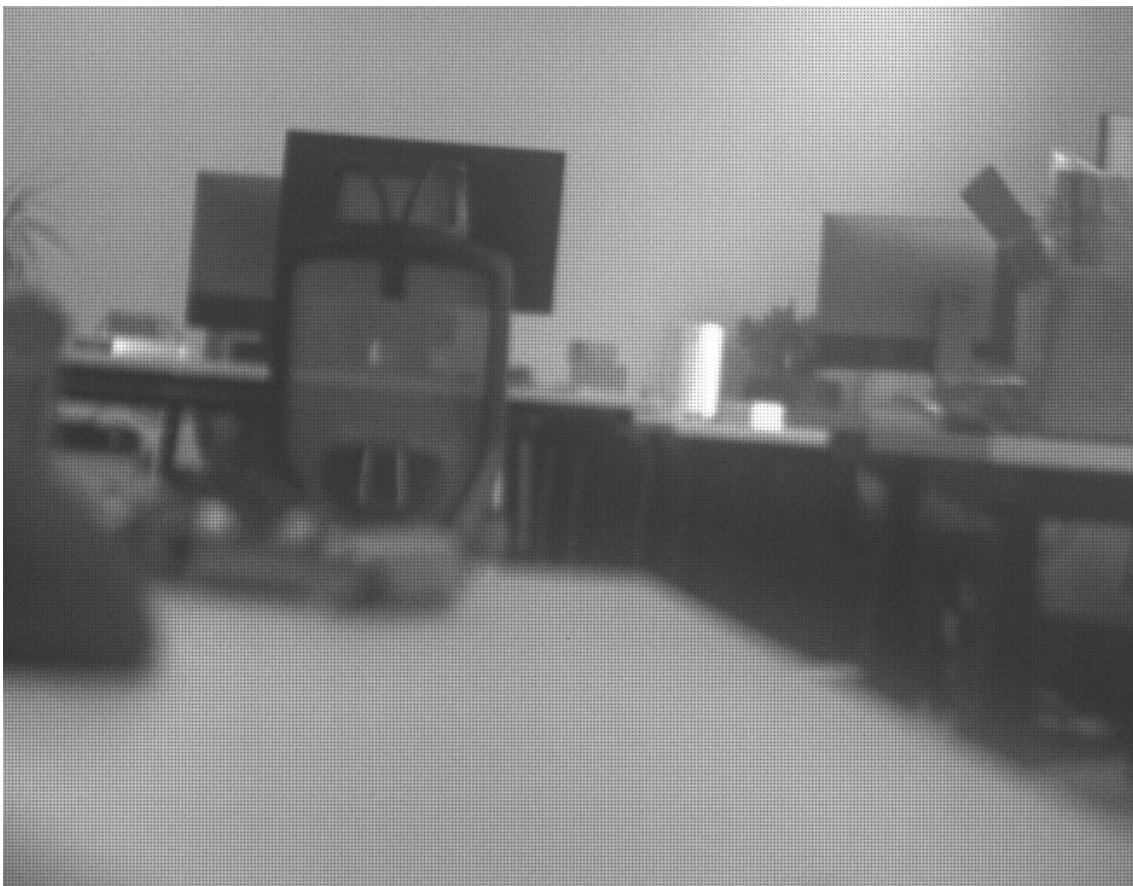
Joonis 14. Töötlemata kaamera sensori pilt halltoonides.
