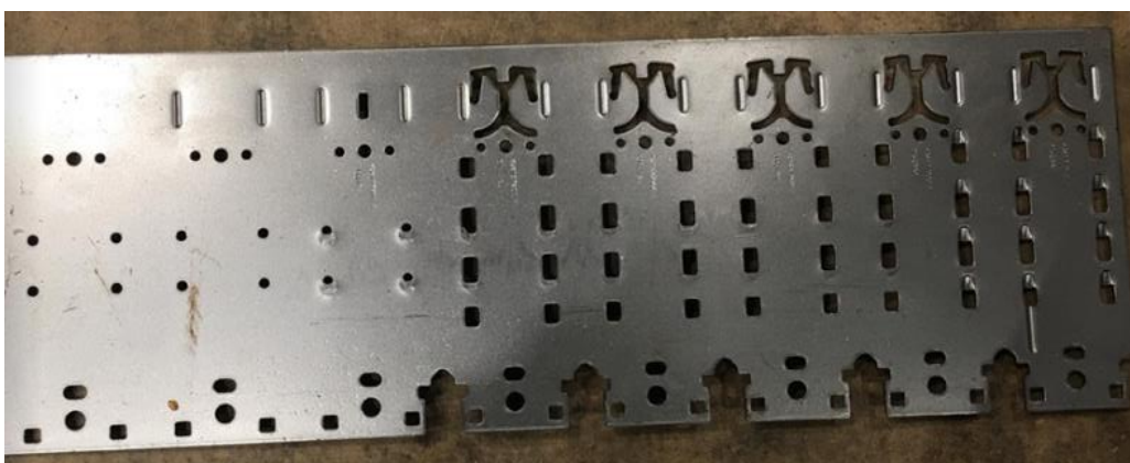
Joonis 2.4 Metall-lint relsi valmistamise kaheksast esimesest sammust
