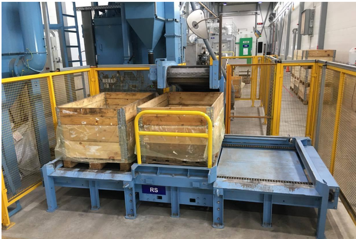
Joonis 2.10 Detailide pakkimine peale haaveldust
