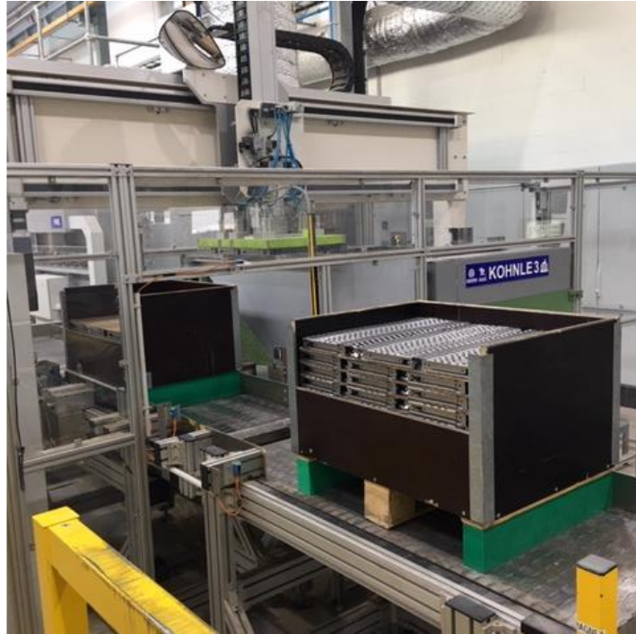
Joonis 2.8 Kastid relssidega karastusliini etteandel
