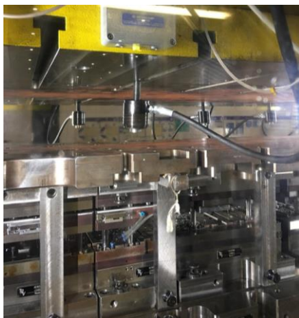
Joonis 2.5 Rakise hüdraulilised kinnitused
