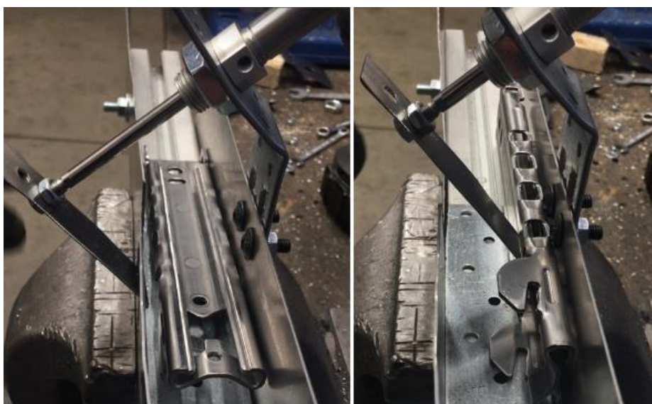
Joonis 5.14 Relsi küljele keeramise jaama prototüüp
