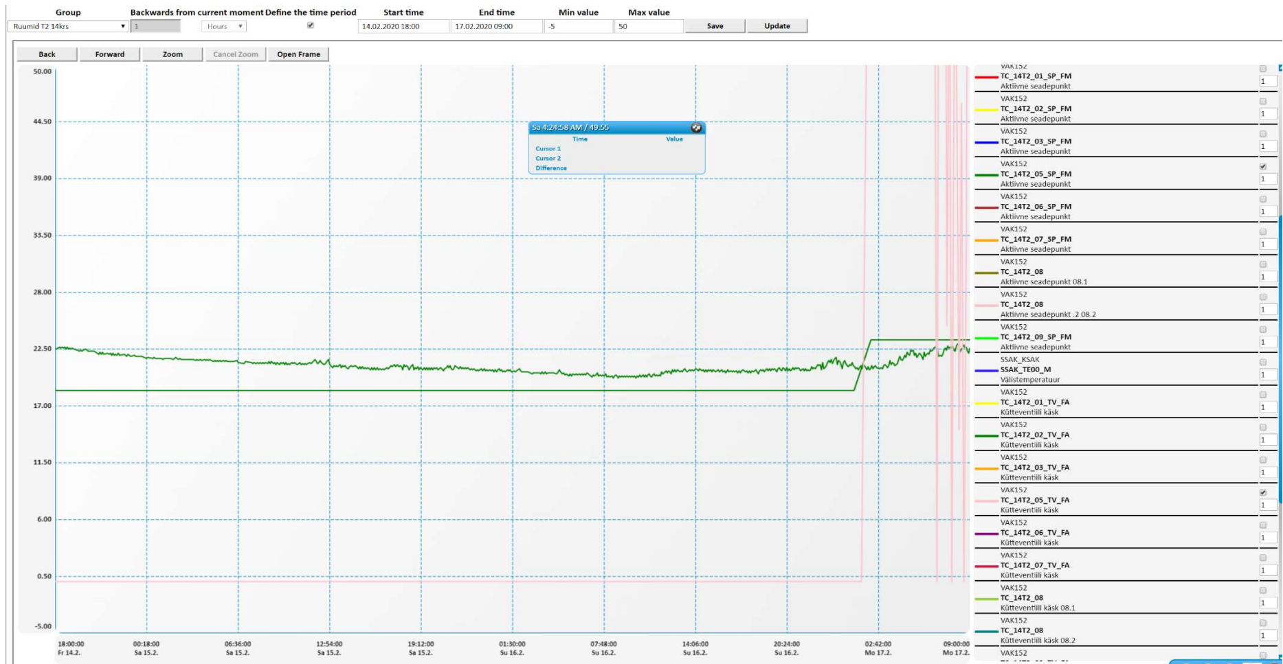
Pilt 35. Ruumi 14-T2-05 kütte reguleerventiili asendid pinnatemperatuuride mõõtmise ajal
