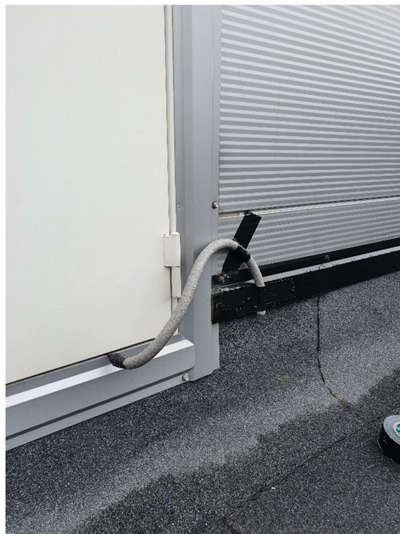
Pilt 12. Torn 2 15 korrus (tehnoruum). Õhurõhuvahe muunduri ja andmelogi asetsemine. Atmosfääri õhurõhu mõõtmistraat ukseavas VU (paremal) on tuulest kaitsetorus sees.
