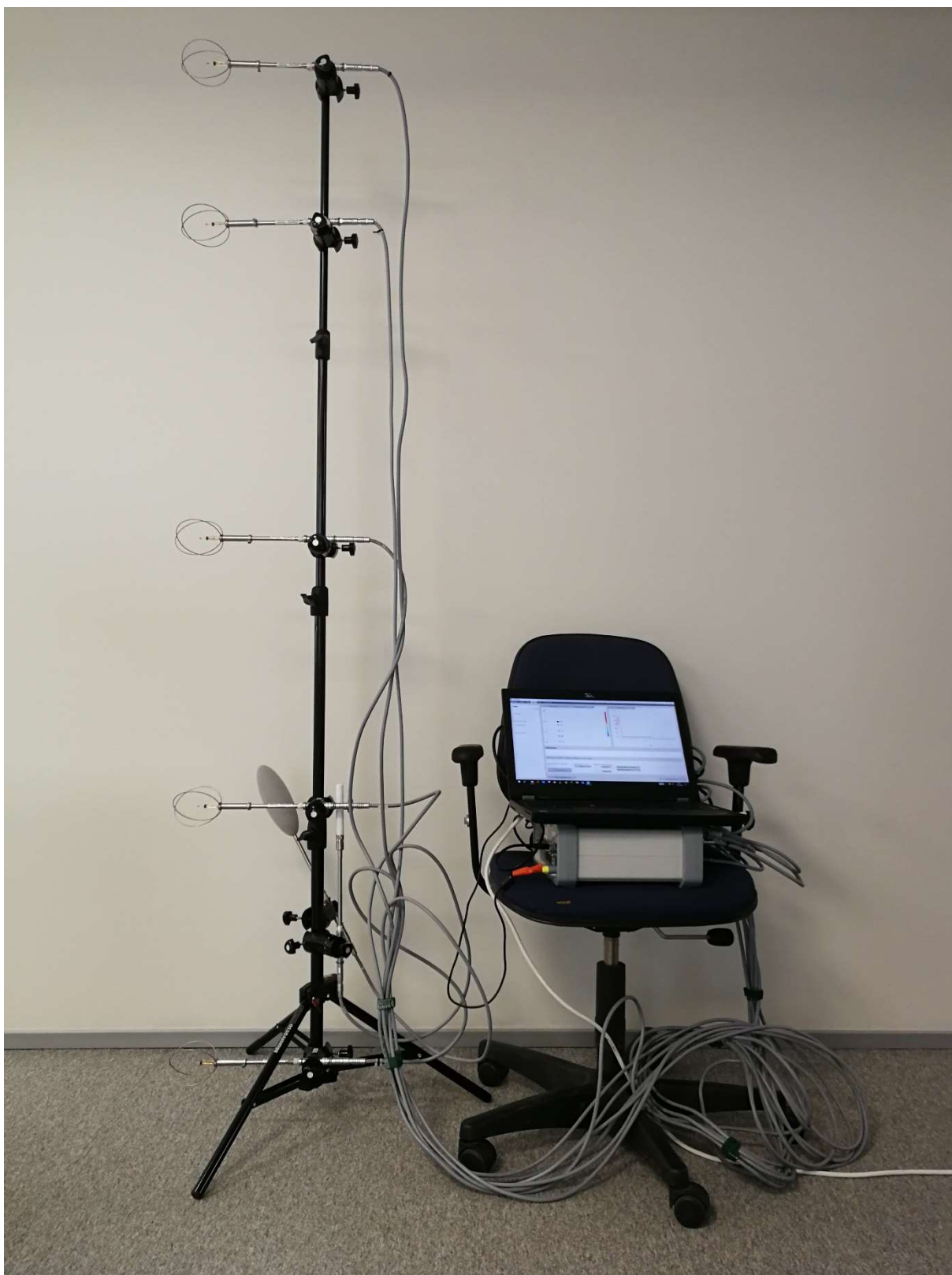
Pilt 2. Uurimisalas kasutatud soojusliku sisekliima mõõtesondide komplekt.
