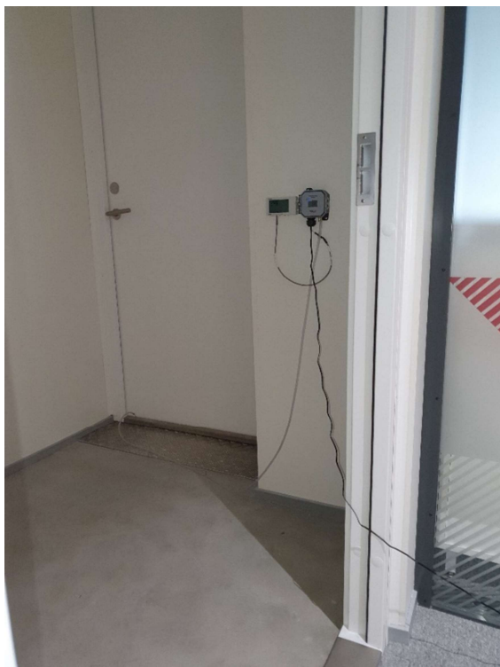
Pilt 11. Torn 2 13 korrus. Õhurõhuvahe muunduri ja andmelogi asetsemine. Õhurõhu mõõtmistraat ukseavas U2 välisrõdu poolt (paremal).
