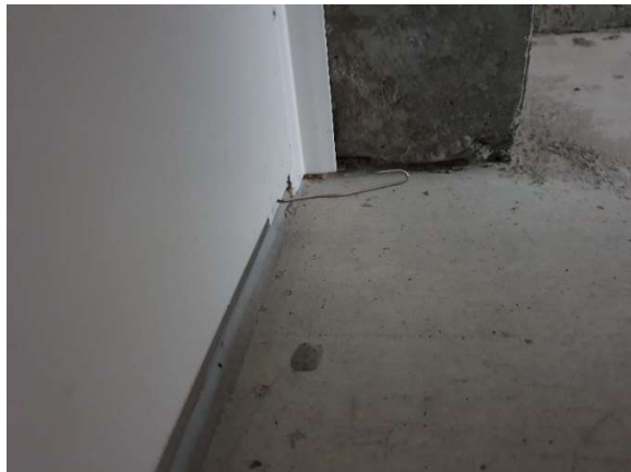
Pilt 11. Torn 2 13 korrus. Õhurõhuvahe muunduri ja andmelogi asetsemine. Õhurõhu mõõtmistraat ukseavas U2 välisrõdu poolt (paremal).
