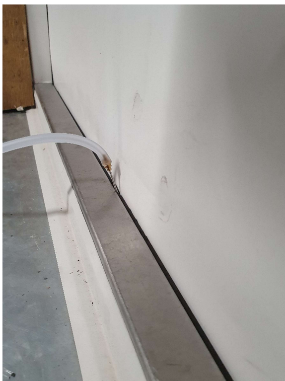
Pilt 17. Atmosfääri rõhu mõõtmistraat ukseavas VU : vasakul tehnoruumi poolt ja paremal katuse poolt (tuulest kaitsetorus sees).
