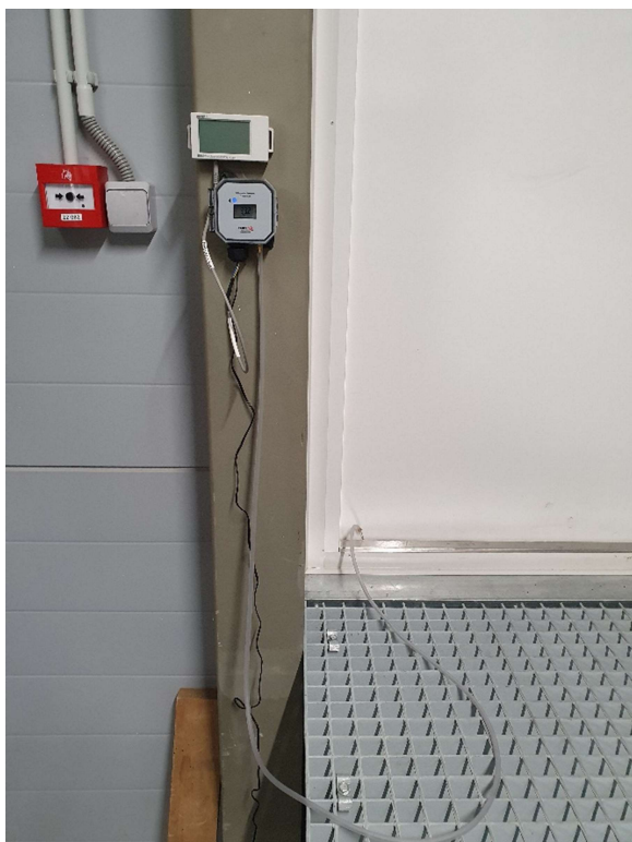
Pilt 12. Torn 2 15 korrus (tehnoruum). Õhurõhuvahe muunduri ja andmelogi asetsemine. Atmosfääri õhurõhu mõõtmistraat ukseavas VU (paremal) on tuulest kaitsetorus sees.
