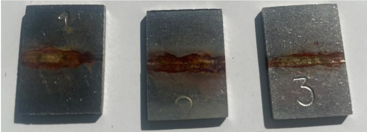
Joonis 4.30 AISI 430 katse lõpus [Autori foto]
