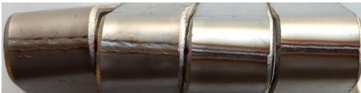
Joonis 4.34 Näidis vabalt valitud katsekehadest, mis ei purunenud [Autori foto]
