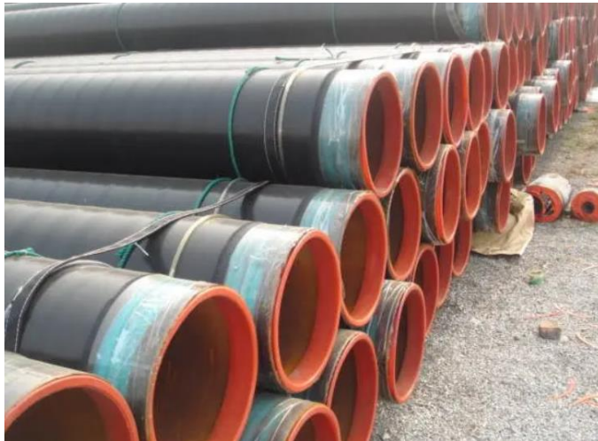
Joonis 2.7. Terastorustik PE korrosiooni kaitsekattega [12]
