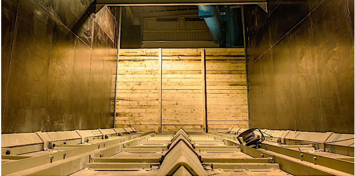
Joonis 3.5 Foto 350 m 3 hakkelaod põrandal olev kraaptrasportöör [6]
